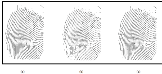
Figura 50: Impressões digitais: (a) afinamento por Zhang-Suen, (b) afinamento por Stentiford, (c) afinamento por Holt.
