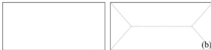
Figura 11: Transformação do eixo medial: (a) forma original, (b) respectiva MAT.
