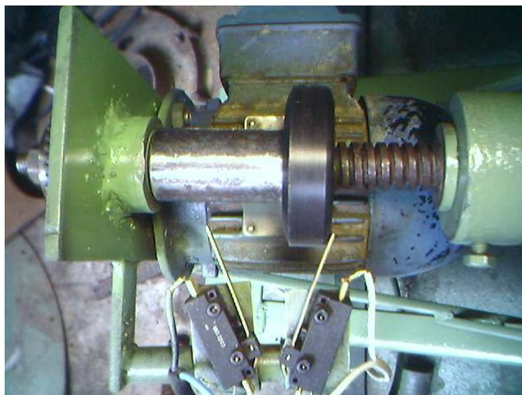
Figura – 5 Sistema de controle de duas posições
