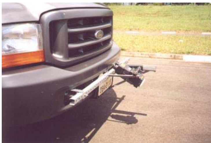
Figura 13. Detalhe da fixação do sensor de velocidade radar no veículo utilitário.
