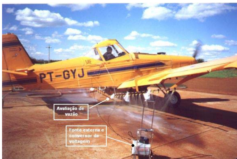
Figura 32. Calibração de vazão em solo, detalhe de individualização de coleta de volume nos bicos e fonte de alimentação com conversor de voltagem.
