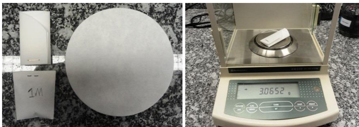
Figura 34 – Sachê de papel filtro utilizado para a realização da determinação do teor de extrativos totais.
