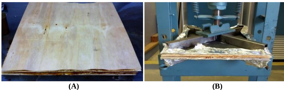
Figura 21 – Processo de produção do compensado; (A) Sobreposição das sete lâminas; (B) Pré-prensagem a frio.
