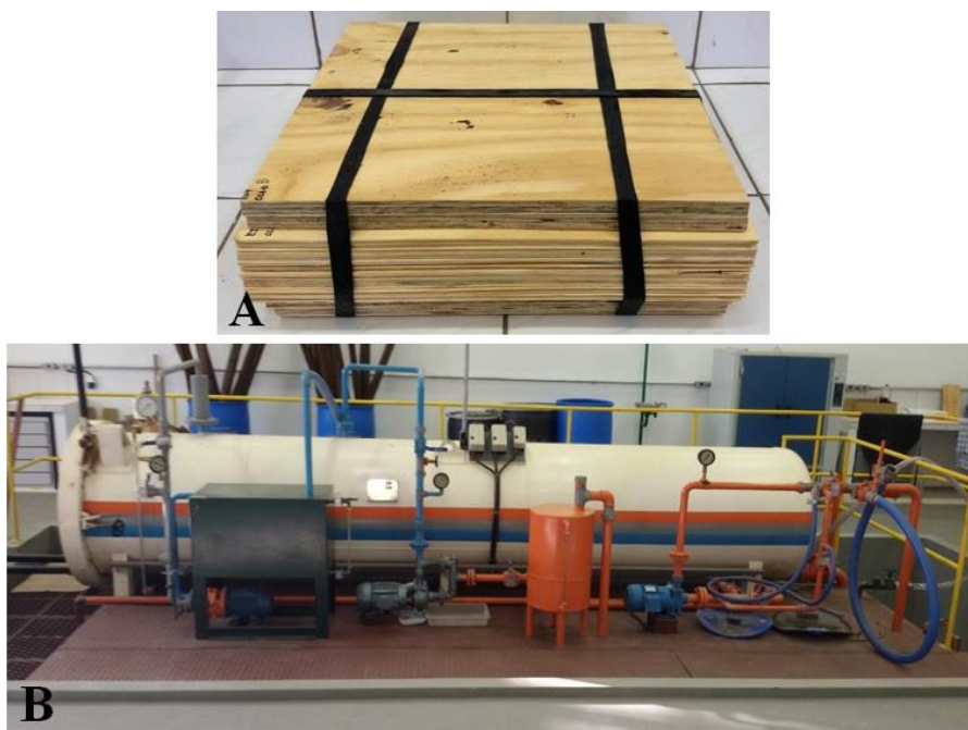
Figura 25 – Tratamento com CCA; (A) Amarração das lâminas e painéis a serem inseridos na autoclave; (b) Autoclave de preservação de madeira utilizada.
