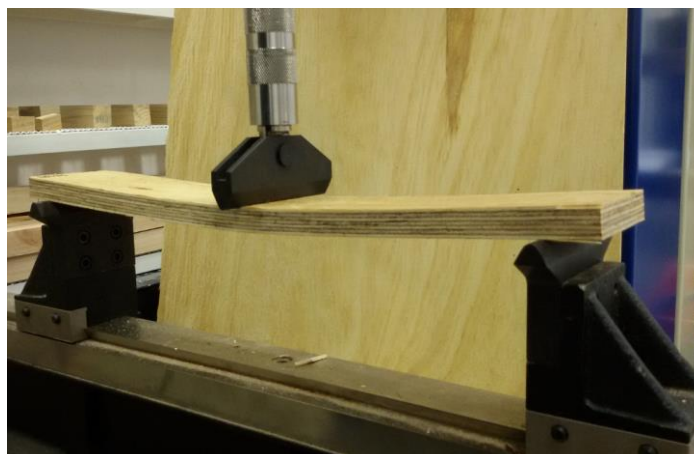
Figura 29 – Ensaio de flexão estática realizado na máquina universal de ensaios EMIC.
