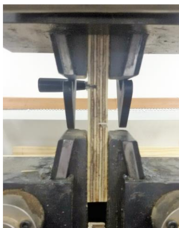
Figura 31 – Ensaio de cisalhamento na linha de cola.
