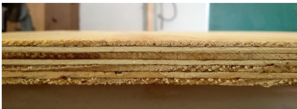
Figura 22 – Painel produzido com sete lâminas.
