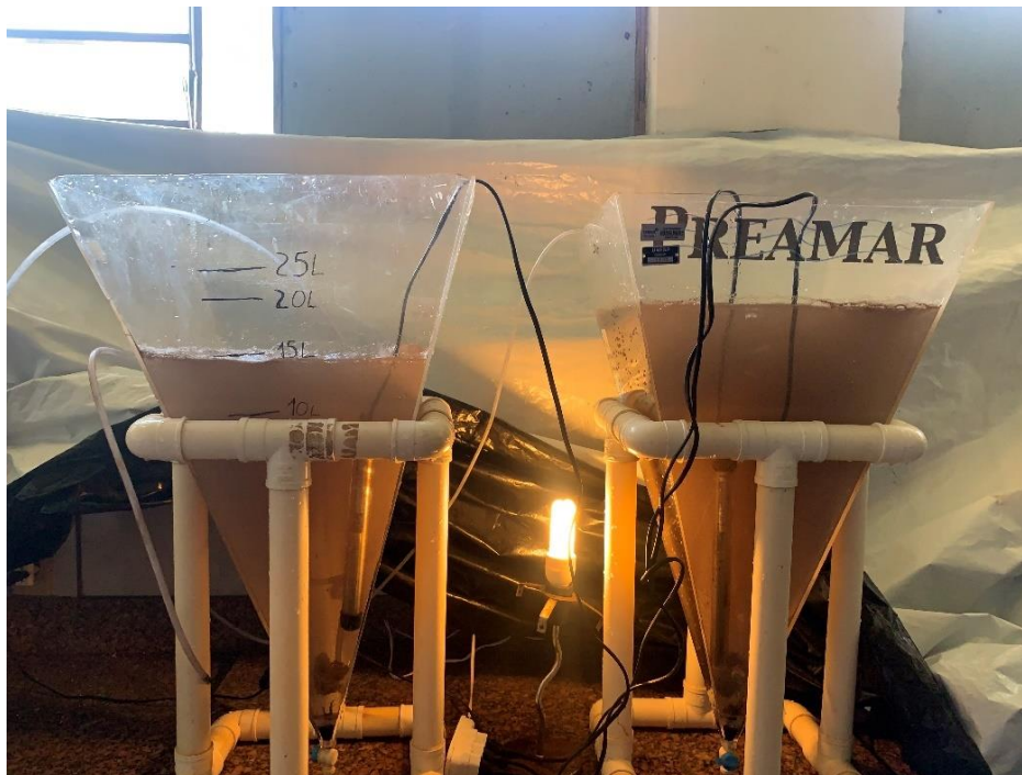
Figura 7. Incubadoras utilizadas para a eclosão dos náuplios de artêmia. (Fonte: O autor)
