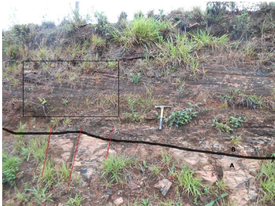
Figura 22: Contato entre siltito (A) e arenito (B) e destaque para estratificação cruzada de baixo ângulo marcada na porção superior. As fraturas de direção N20E/Subverticais, destacadas em vermelho, cortam ambas as litologias.
