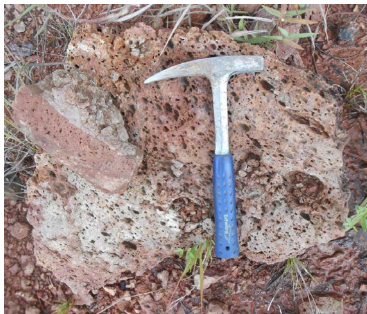
Figura 35: Riólito com estrutura vesicular com pequena orientação do fluxo de lava.
