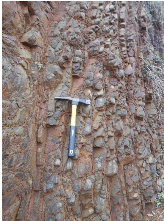
Figura 38: Padrão de juntas subverticais no diabásio. Ponto 9.
