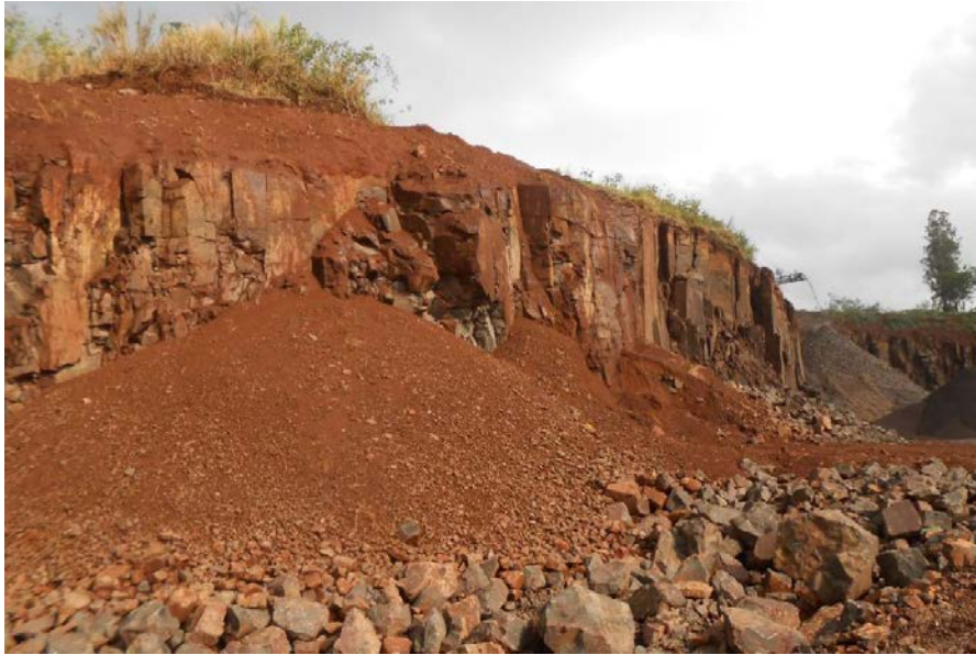
Figura 34: Pedreira de basalto com notável família de fratura vertical de atitude N72E/85NW.
