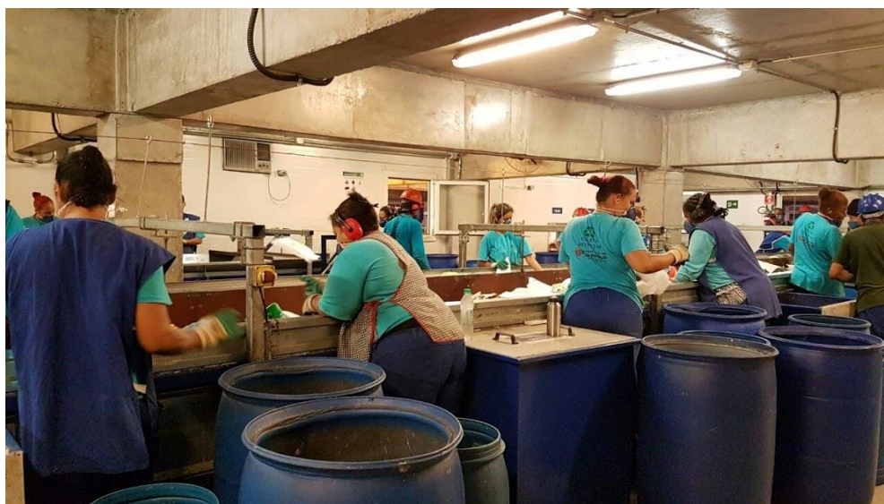
Figura 20. Processo de triagem e controle de qualidade manual, ao final do processo da triagem mecanizada na CMT Ponte Pequena, São Paulo – SP (Oliveira, 2019).
