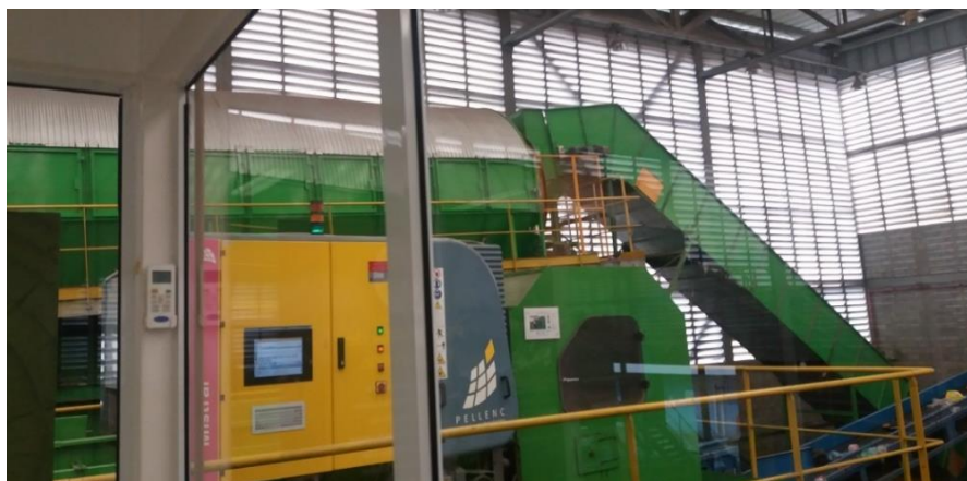
Figura 25. Fotografia do direcionamento do resíduo para o Trommel na CMT-Sudeste (Jacinto, 2019).
