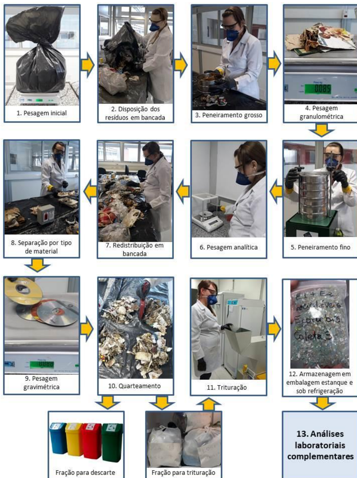
Figura 31. Esquema da metodologia laboratorial realizada para caracterização dos RSU secos (Jacinto, 2019).
