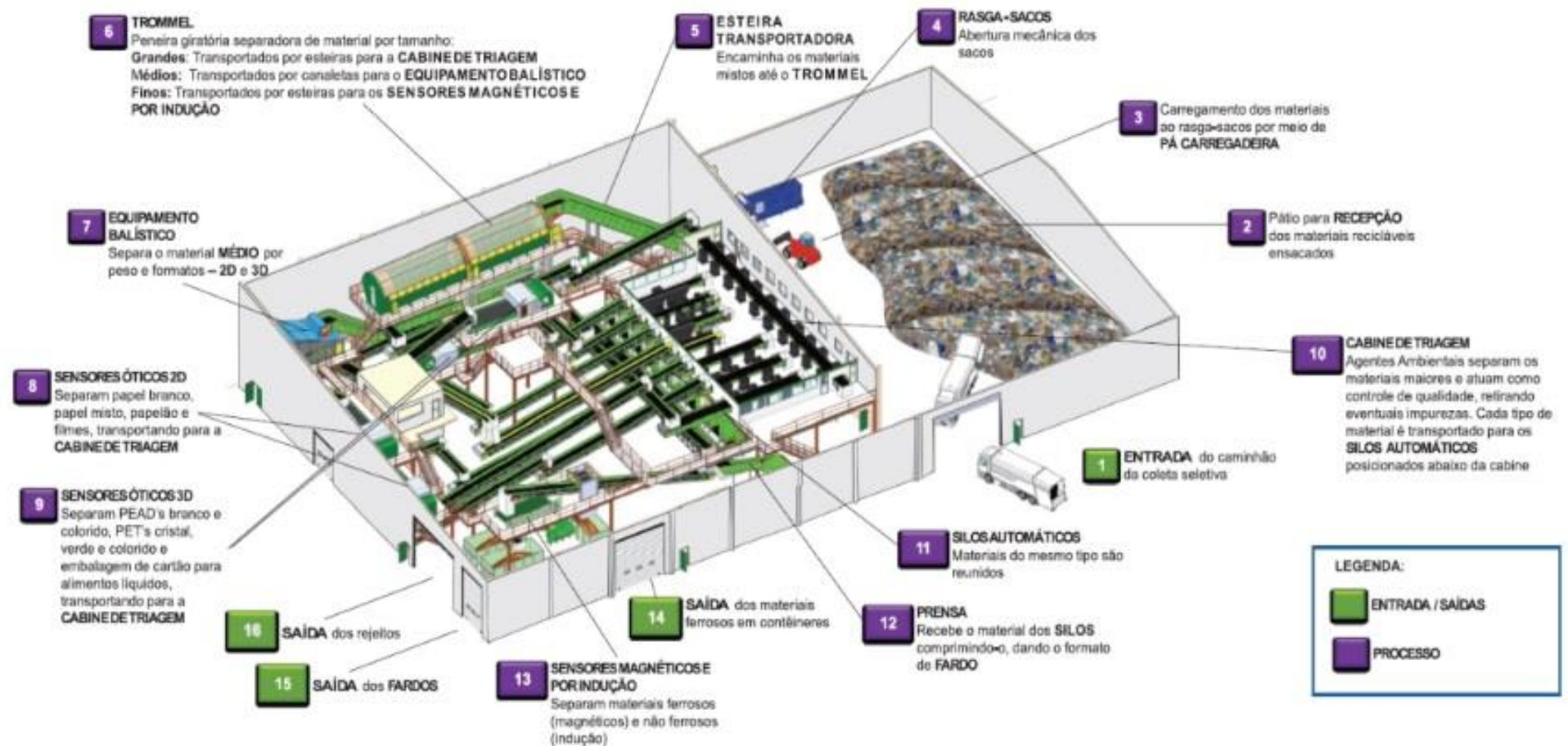
Figura 23. O caminho do material reciclável dentro da Central Mecanizada de Triagem – Carolina Maria de Jesus construída para receber os RSU secos do agrupamento sudeste da cidade de São Paulo (Ecourbis Ambiental, 2019).
