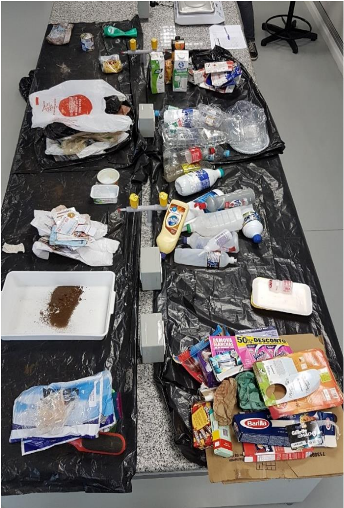
Figura 30. Separação gravimétrica sobre bancada segundo a tipologia de material.
