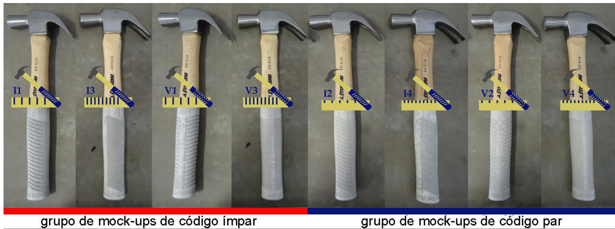
Figura 3.5 – Mock-ups: 4 modelos de textura grande profundidade (código ímpar) e 4 modelos de textura pequena profundidade (código par).
