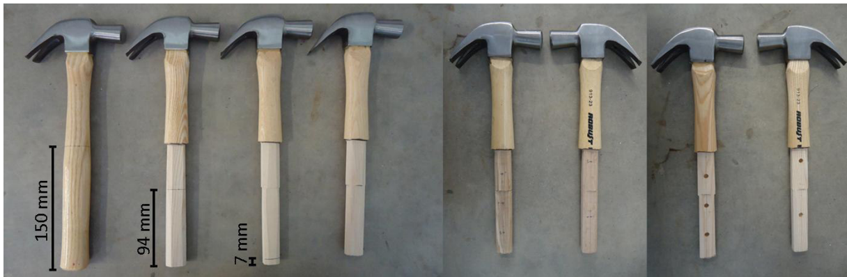
Figura 3.11 – Fases de desbaste (esquerda) e perfuração do cabo dos martelos (direita).
