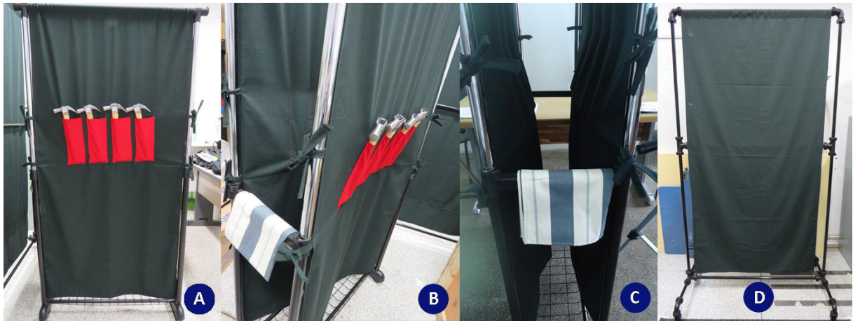
Figura 3.18 – Araras: arara dupla com regulagem de altura (A), com duas cortinas com quatro bolsos para armazenar os mock-ups (B,C); arara desmontável com dois níveis, com uma cortina (D).
