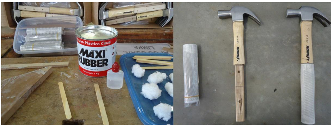
Figura 3.12 – Materiais utilizados para fixação das peças de textura ao cabo de madeira.
