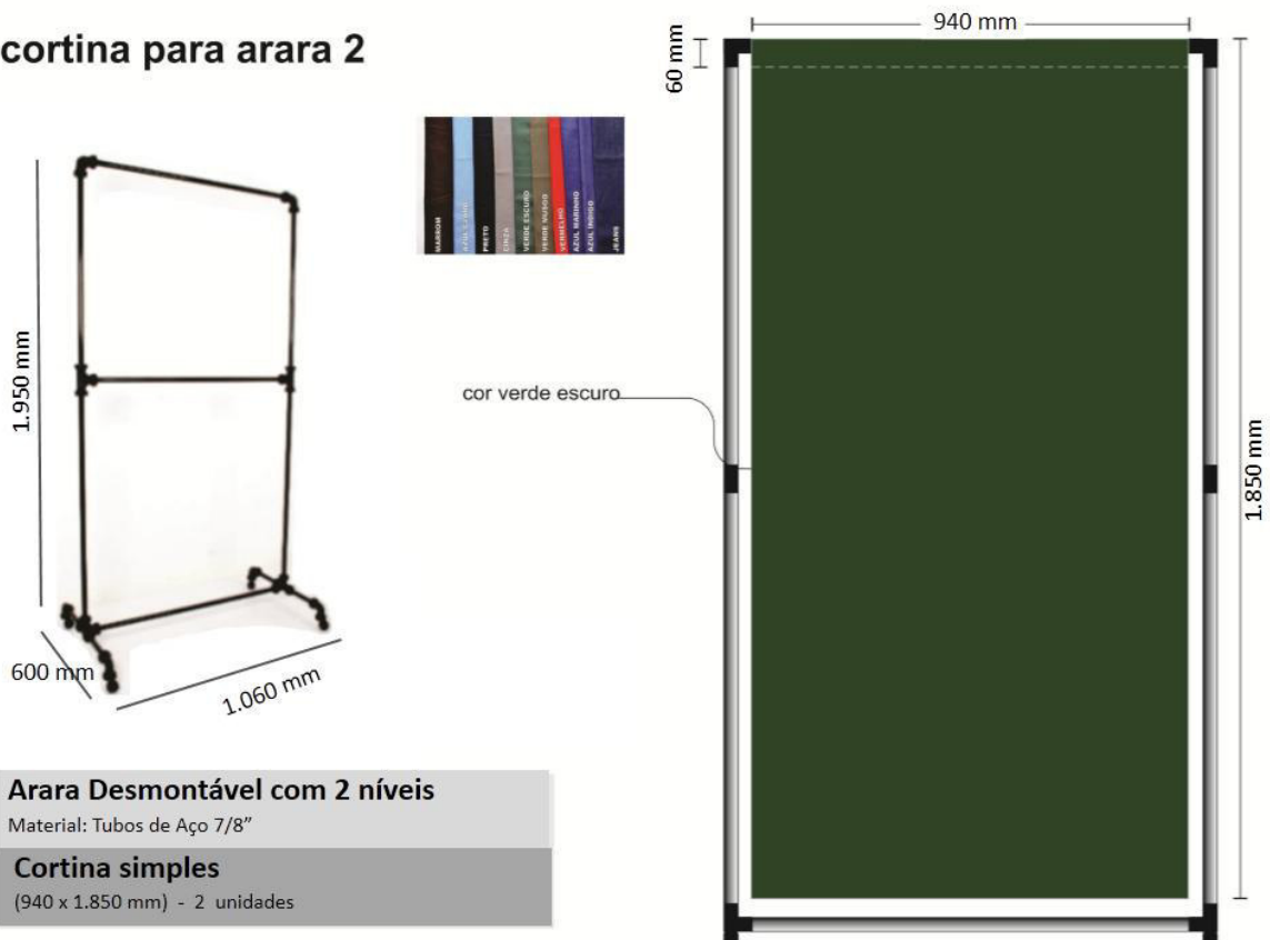
Figura 3.21 – Especificações da arara desmontável com dois níveis, com uma cortina.
