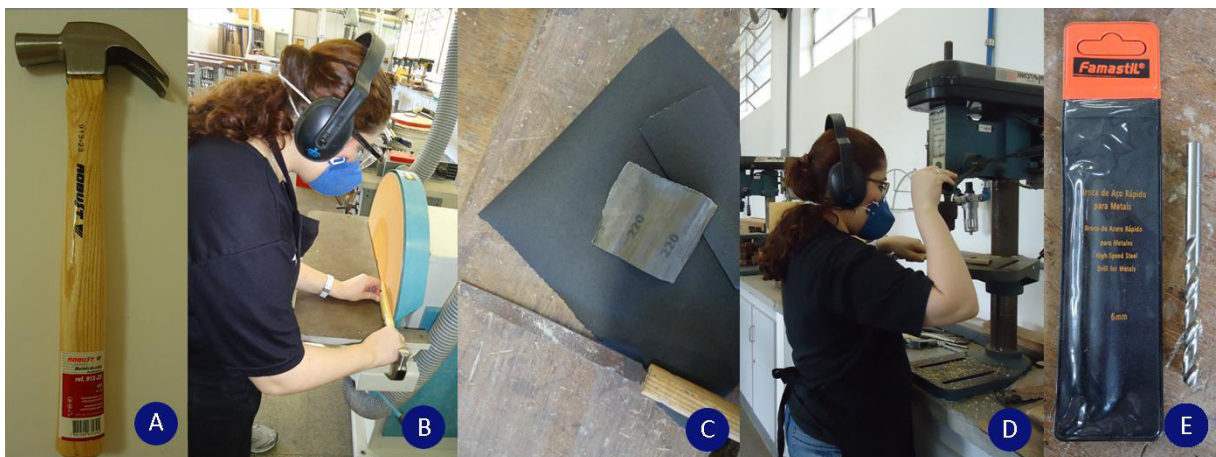
Figura 3.10 – Material para lixamento e perfuração do cabo de madeira.
