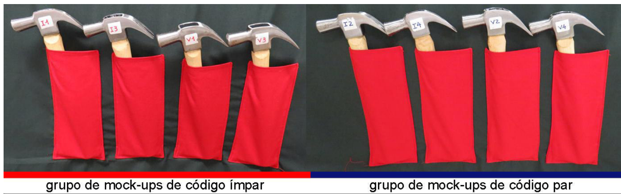
Figura 3.20 – Mock-ups com etiquetas de identificação e textura omitida visualmente pelo bolso da cortina.
