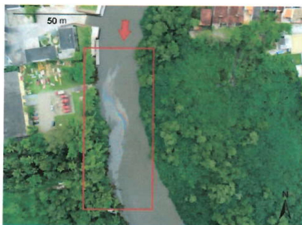
Figura 30: ortofoto de drone orientada e escalada mostrando a mancha de óleo próxima a margem côncava deste rio.
