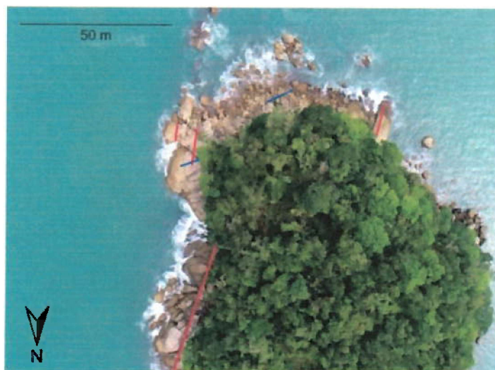
Figura 19: ortofoto de drone orientada e escalada mostrando em vermelho as fraturas com direção NE-SW e em azul as fraturas NW-SE.
