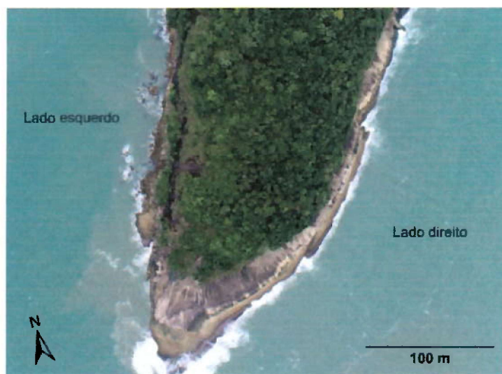
Figura 17: ortofoto de drone orientada e escalada mostrando do lado direito um maciço liso e exposto e um maciço mais fraturado e com alguns matacões do lado esquerdo.
