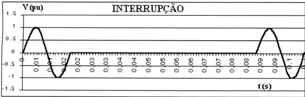
Figura 1.2 Forma de onda da tensão durante uma Interrupção.
