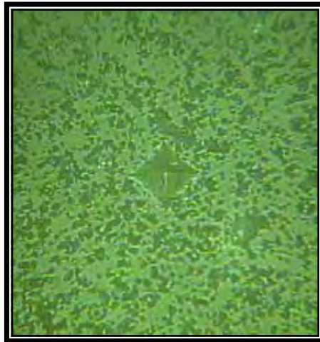
FIGURA 30 – Superfície pós-polimento e marca deixada pelo diamante na cerâmica In-Ceram® AL (Grupo G2)
