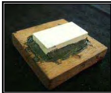
FIGURA 12 – Fixação de uma das lâminas na base de madeira.
