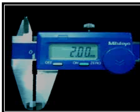
FIGURA 16 – Aferição das medidas do corpo-de-prova com paquímetro digital
