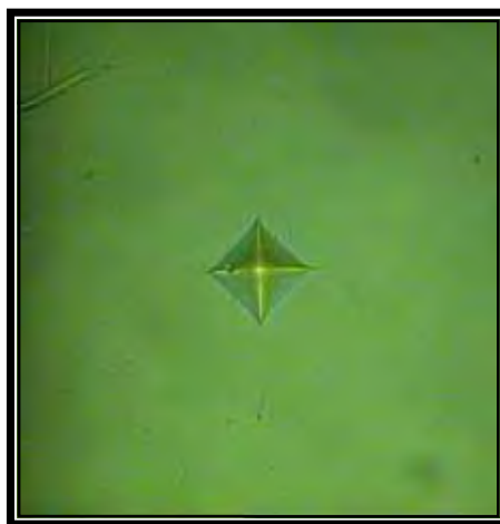
FIGURA 32 – Superfície pós-polimento e marca deixada pelo diamante na cerâmica In-Ceram® YZ (Grupo G4)
