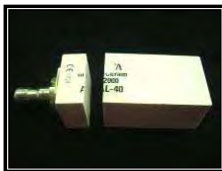
FIGURA 8 – Haste metálica removida e determinação do comprimento dos corpos-de-prova.
