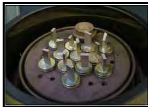
FIGURA 28 – Fragmentos cerâmicos a serem metalizados com ouro.
