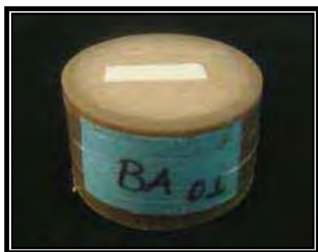
FIGURA 23 – Corpo-de-prova incluído no tubo de PVC.
