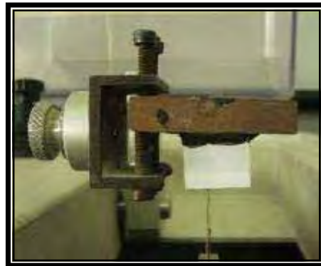
FIGURA 10 – Corte longitudinal para determinar a largura.
