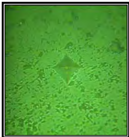
FIGURA 29 – Superfície pós-polimento e marca deixada pelo diamante na cerâmica In-Ceram® Alumina (Grupo G1)
