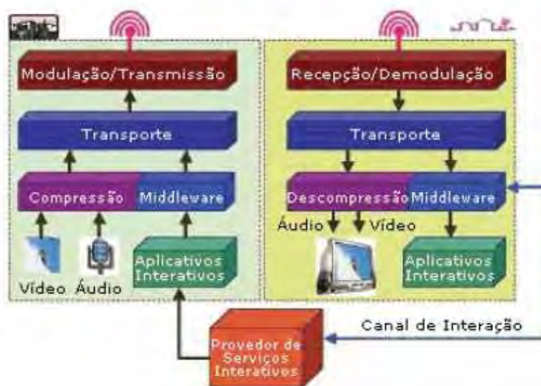
Figura 1 – Diagrama de blocos do funcionamento da televisão digital
