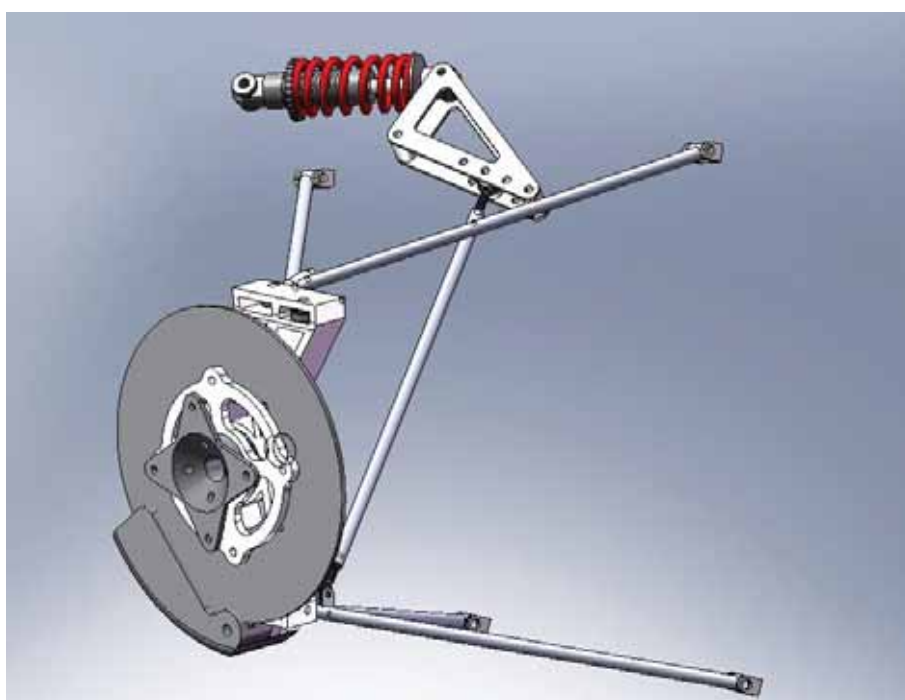
Figura 2. Desenho do conjunto de freio do Formula SAE
