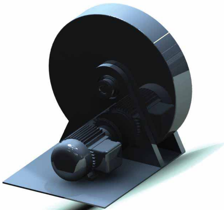
Figura 10. Volante para bancada com vista para o motor e polias
