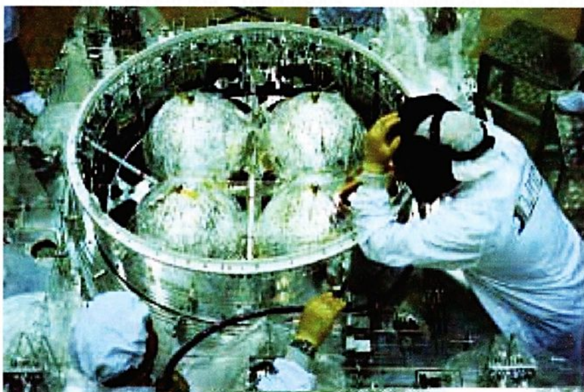
Figura 5.20 – Ponteamento na região dos tanques
