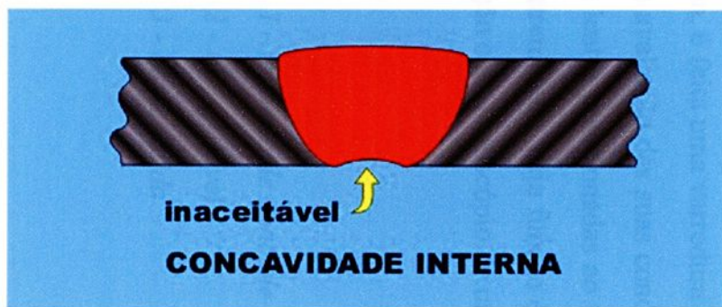
Figura 3.37 – Condições de aprovação e rejeição dos cordões de solda
