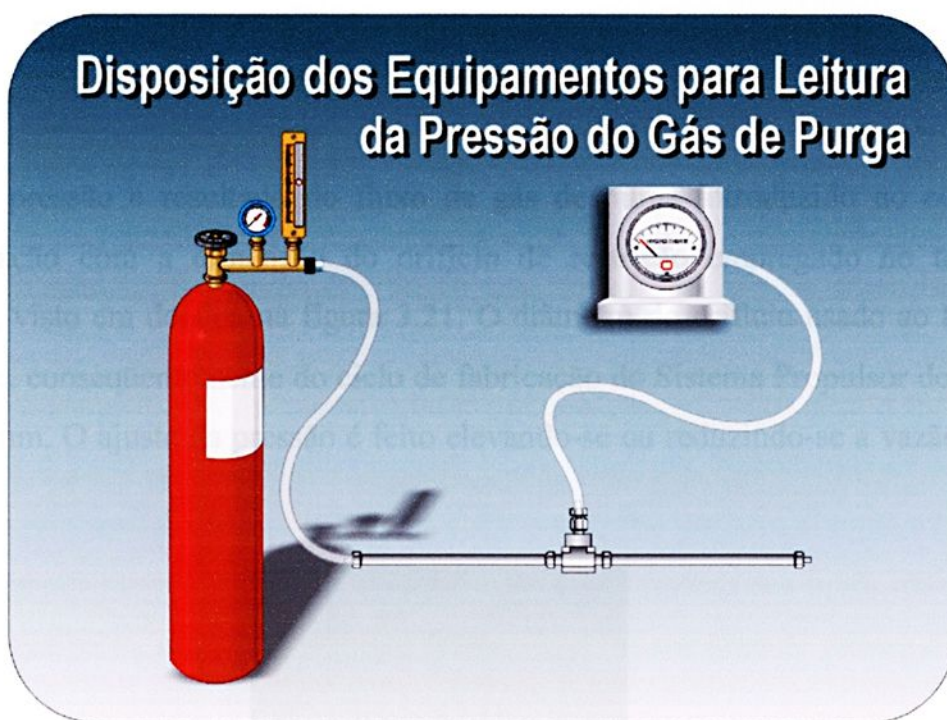
Figura 3.19 – Arranjo dos equipamentos para a leitura da pressão
