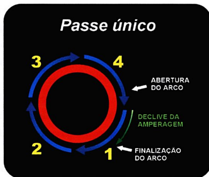
Figura 2.5 – Ciclo de soldagem para tubos de pequenos diâmetros
