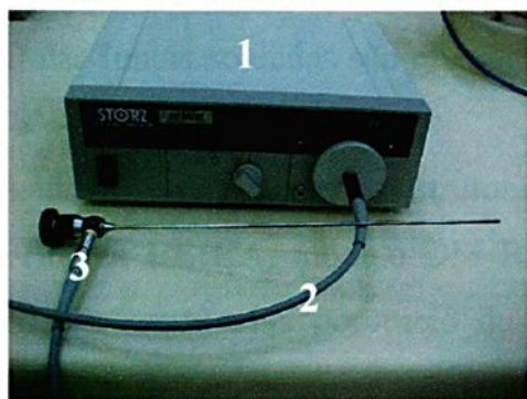
Figura 3.38 – Boroscópio; instrumento para examinar as superfícies internas das juntas soldadas
