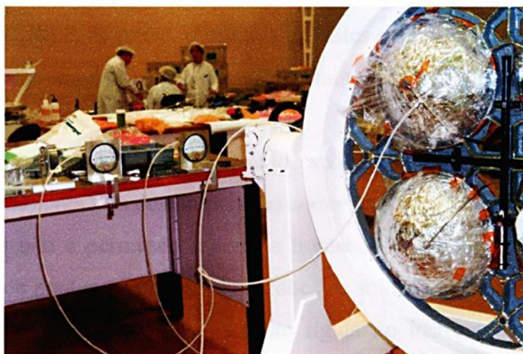
Figura 5.16 – Verificação da pressão em uma junta próxima aos tanques de hidrazina
