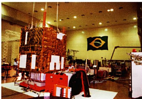
Figura 1.2 – Satélite CBERS durante ensaio de vibração (cortesia INPE/LIT)
