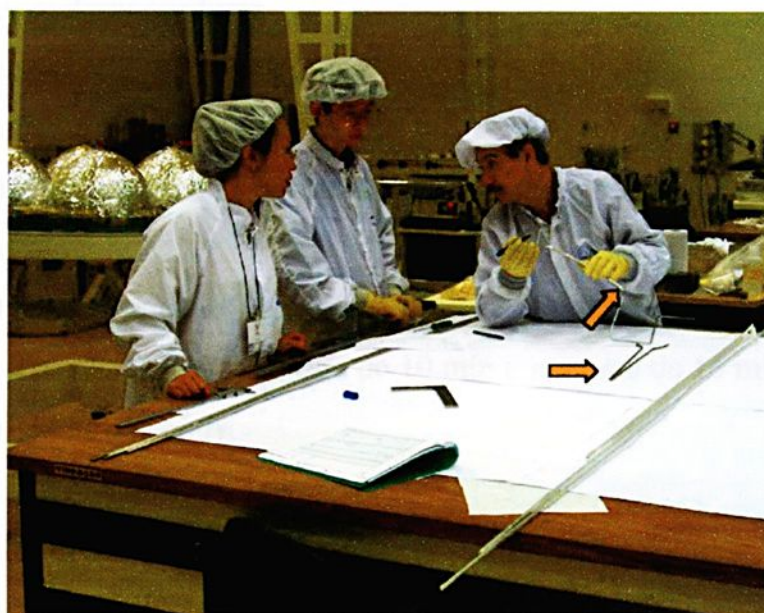
Figura 5.5 – Setor de verificação dos tubos dobrados
