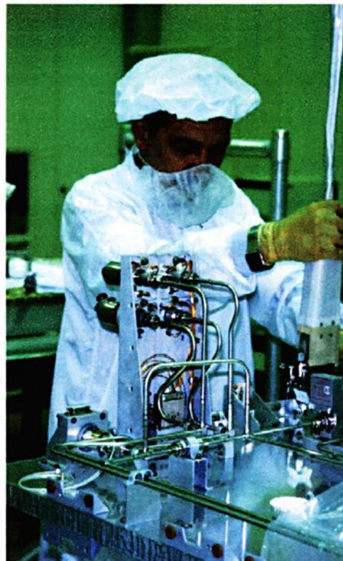
Figura 2.16 – Soldagem orbital do Sistema Propulsor do Satélite CBERS
