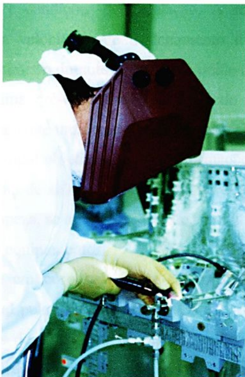
Figura 5.19 – Operação de ponteamento no próprio Satélite
