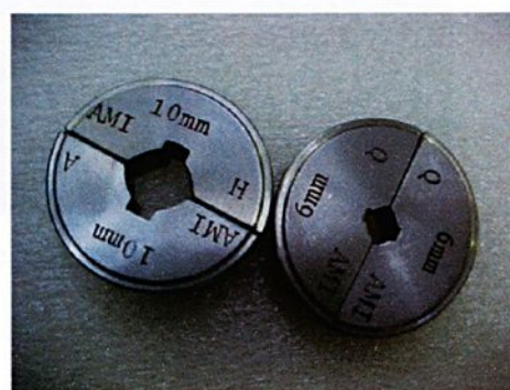
Figura 3.27 – Exemplos de alojadores para tubos de diferentes diâmetros
