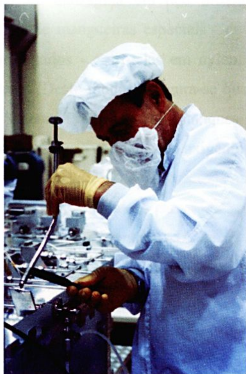
Figura 5.9 – Inspeção visual de uma junta momentos antes do ponteamento manual
