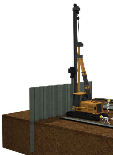
Figura 1: a) tipos de perfil de estaca prancha B) Execução da estaca prancha (PINI, 2011).
