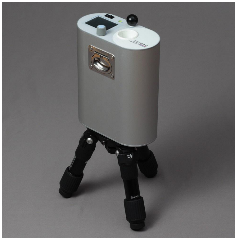
Figura 11. Magnetômetro spinner portátil para medições de AF. A amostra é inserida na abertura do copo na parte superior. Ele gira, gerando uma força eletromagnética que é detectada com um fluxo circular (AGICO, 2022).
