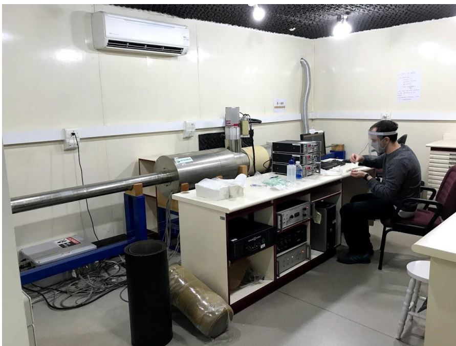
Figura 12. Magnetômetro criogênico. A amostra é inserida na abertura das blindagens. Existem três eixos SQUIDS que detectam o momento magnético que é lido nas três caixas eletrônicas (USPMag, 2022).
