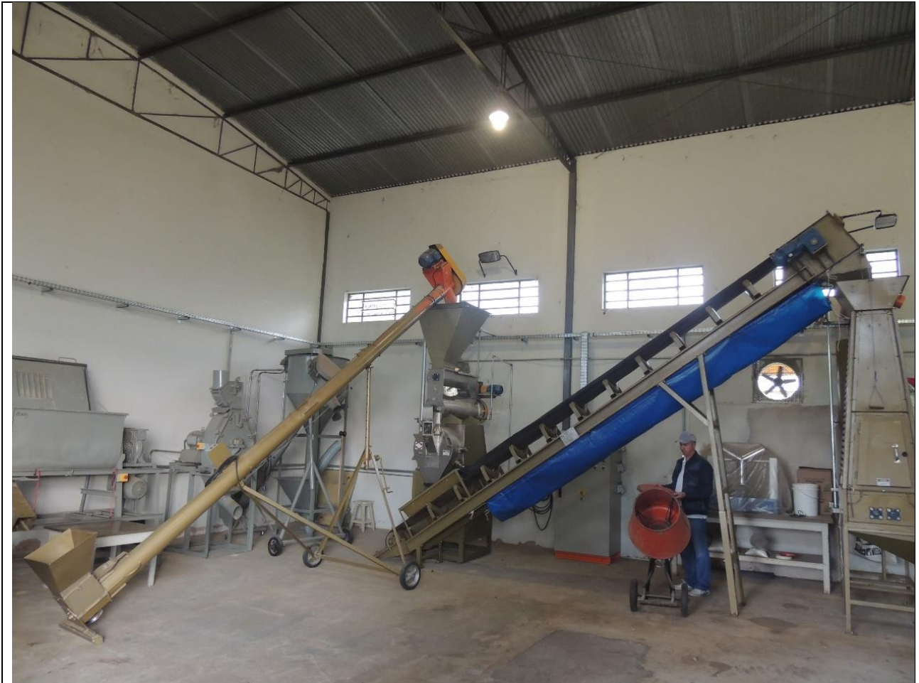
Figura 11. Peletizadora de ração e seus componentes (chupim, esteira e resfriador)
