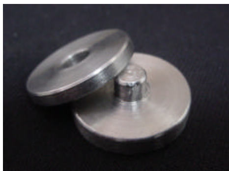
FIGURA 5 – Matriz utilizada para confecção dos espécimes de resistência à tração diametral.
