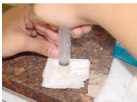
FIGURA 10 – (a) Compactação da massa cerâmica no interior da seringa; (b) Remoção do excesso de aglutinante com papel absorvente; (c) Cilindro cerâmico sendo removido da seringa
