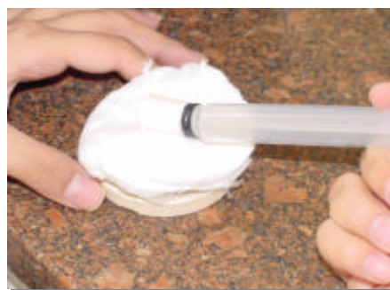
FIGURA 10 – (a) Compactação da massa cerâmica no interior da seringa; (b) Remoção do excesso de aglutinante com papel absorvente; (c) Cilindro cerâmico sendo removido da seringa
