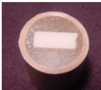
FIGURA 6 – Fragmento do espécime do ensaio de resistência à flexão incluído em resina acrílica.
