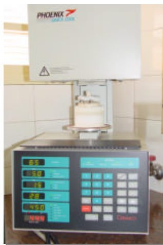
FIGURA 7 – Forno Phoenix (Ceramco), empregado para sinterização.
