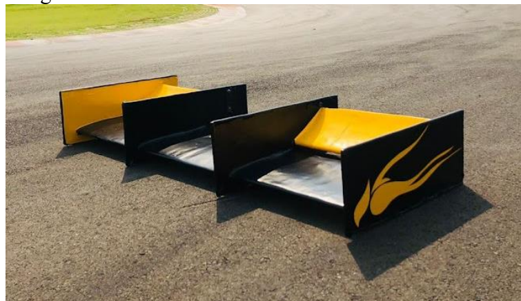
Figura 13 - Asa dianteira de um carro de Fórmula SAE.
