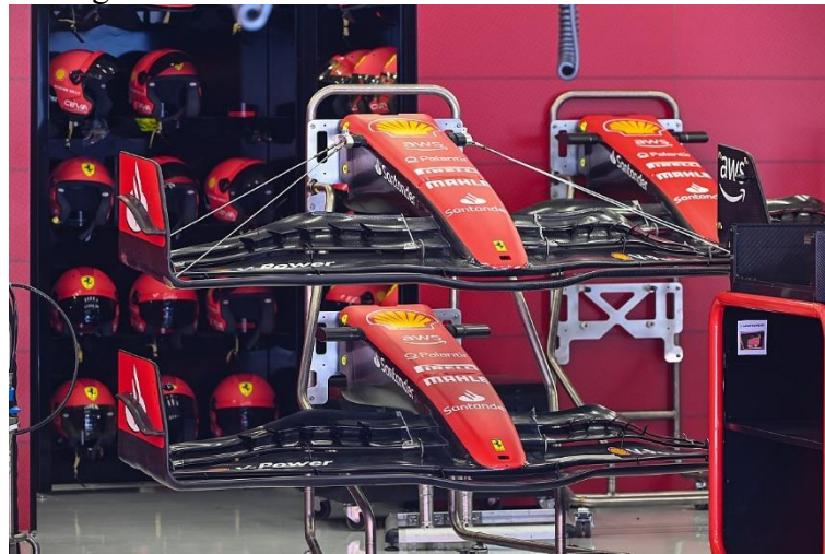
Figura 12 - Asa dianteira de um carro de Fórmula 1
