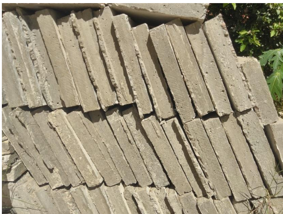
Figura C1 Placas de piso não estruturais moldadas com sobras de concreto
