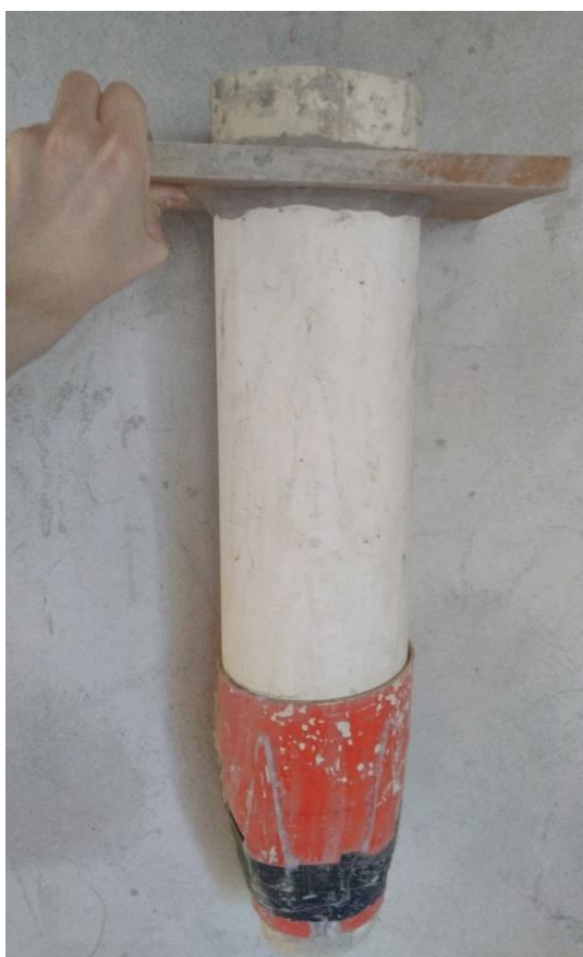
Figura 5.8 Modelo de tubo para ensaio de vazão.
