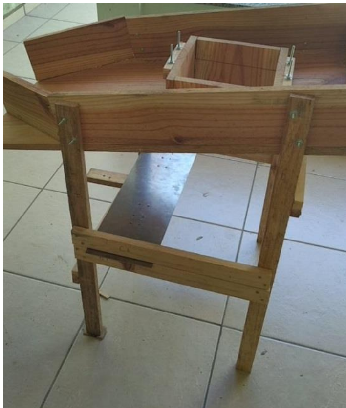
Figura 5.9 Perspectiva do equipamento acoplado à estrutura de suporte.
