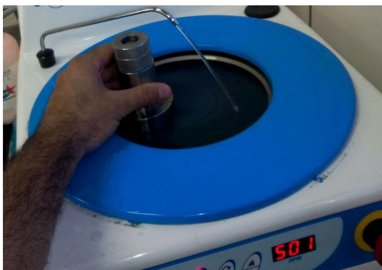
Figura 4.22: Polimento da amostra na sequência de lixas.
