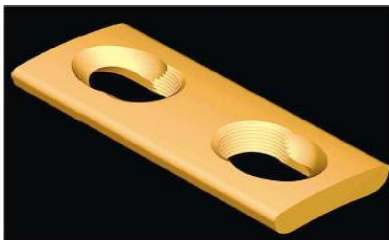
Figura 3.4: Visualização do modelo 3D - furo combinado (FRIGG, 2003b).
