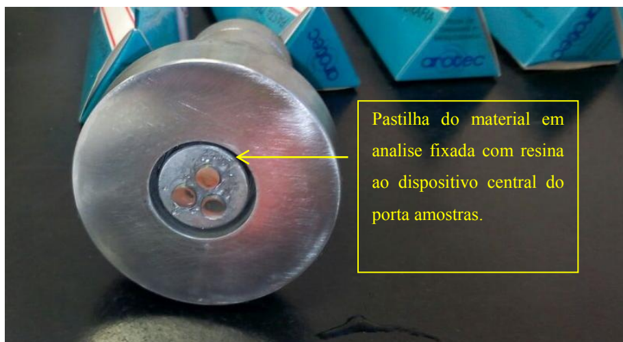
Figura 4.19: Dispositivo porta amostras de tratamento superficial com amostras fixadas para polimento.
