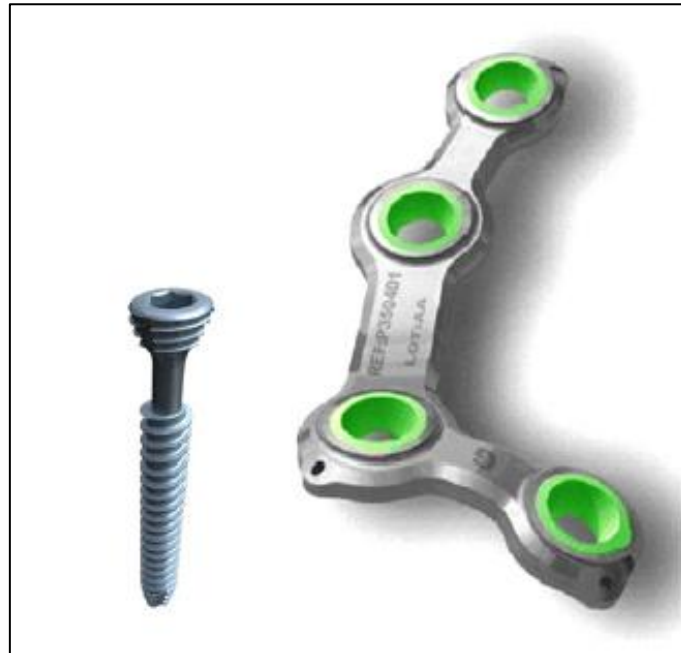
Figura 3.17: Biotech® modelo de placa com sistema de bloqueio. A cabeça do parafuso é roscada e cria rosca no polímero da placa. (CRONIER et al., 2010).
