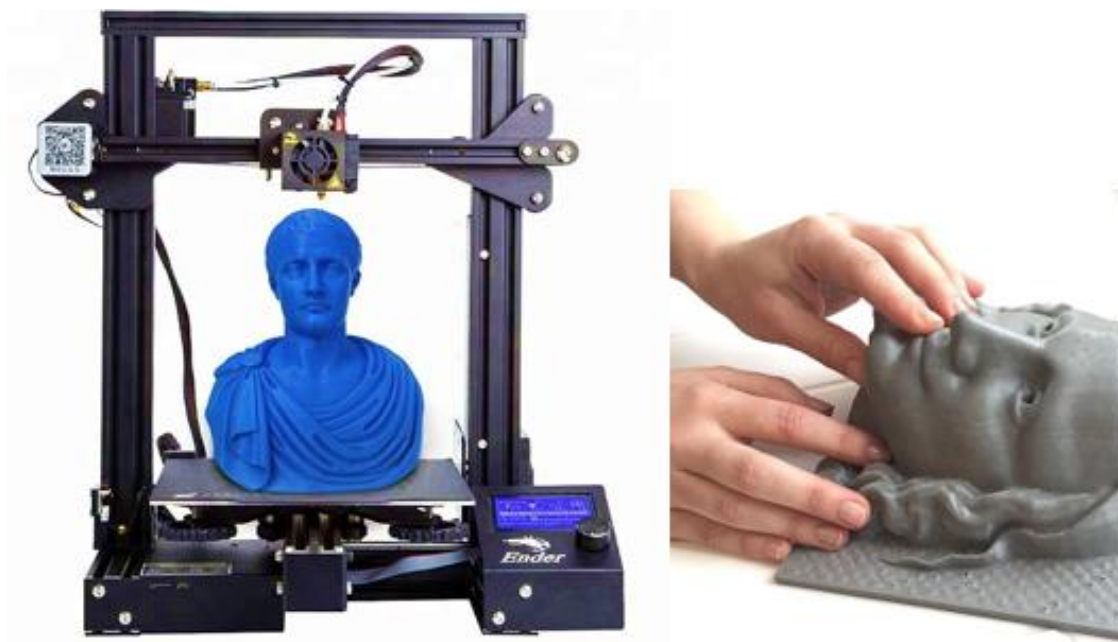
Figura 14 - Impressora 3D e peça de rosto impressa
