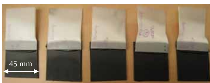
b) Teromix 6700 (PU): Deformação do c.d.p
