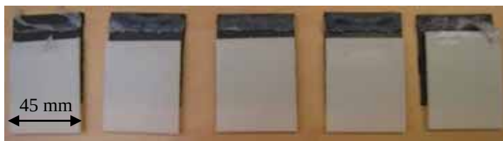
c) Reticulação: 2 semanas - Ruptura adesiva
