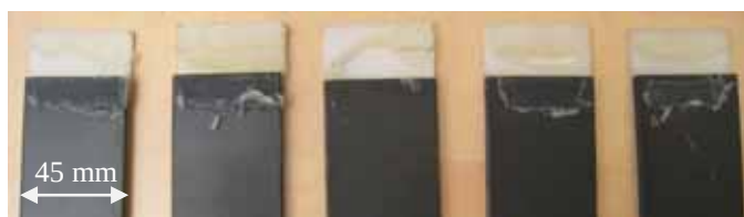
a) Reticulação: 1 semana - Ruptura coesiva
