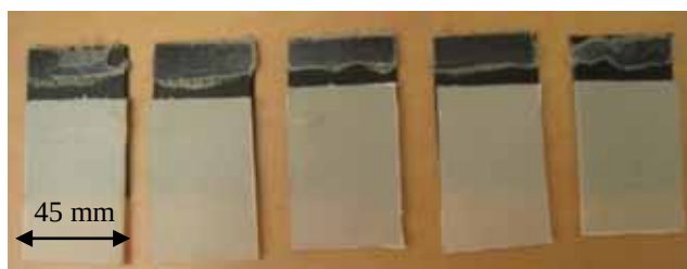
b) ST: Ruptura adesiva
