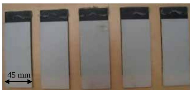
b) ST: Ruptura adesiva
