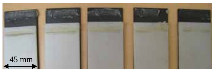
d) Sika 9185 (PP): Ruptura coesiva
