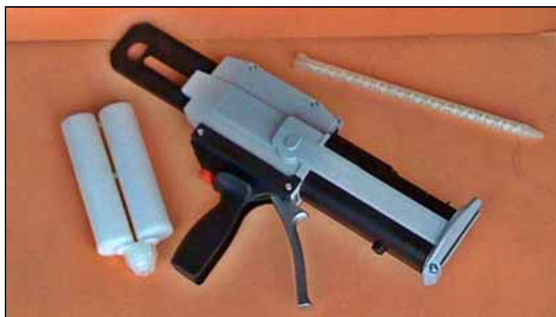
Figura 25 - Pistola aplicadora manual, bico misturador e cartucho bi-componente
