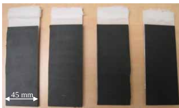
a) Sem: Ruptura adesiva
