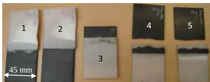
Figura 35 - Amostras após ensaio de Lap Shear das colas hot-melt a -35°C
