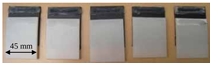
b) Reticulação: 1 semana - Ruptura adesiva
