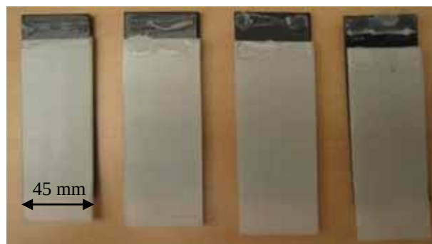
d) Excessivo: Ruptura adesiva
