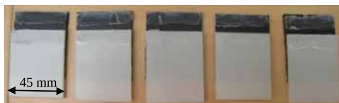
a) Sika 9676 (PU): Ruptura coesiva
