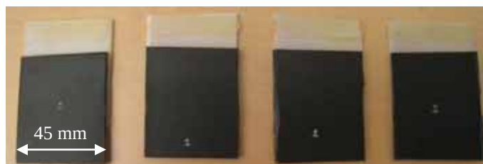
b) SwiftTherm: Ruptura adesiva
