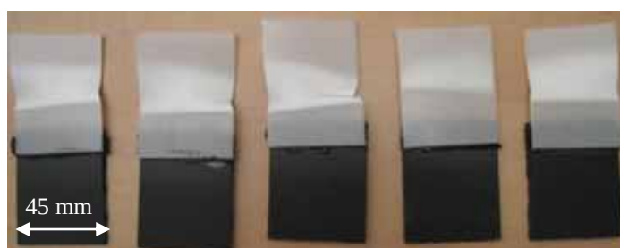
b) Teromix 6700 (PU): Deformação do c.d.p
