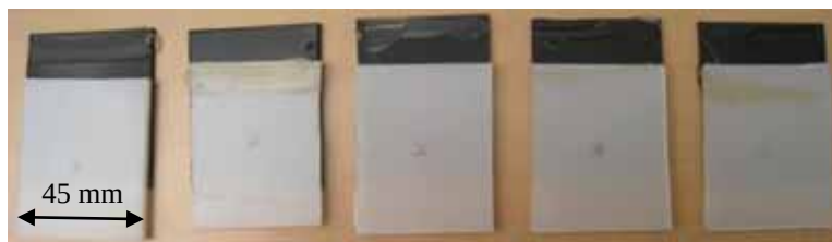
e) Swift Therm (PP): Ruptura adesiva
