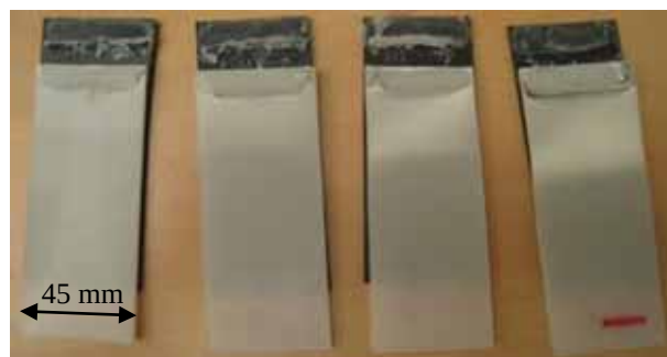
c) Normal : Ruptura coesiva
