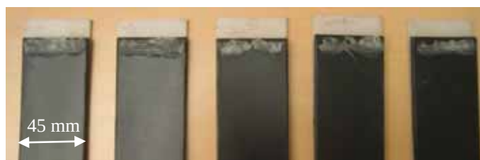
b) Swift Lock (PU): Ruptura mista
