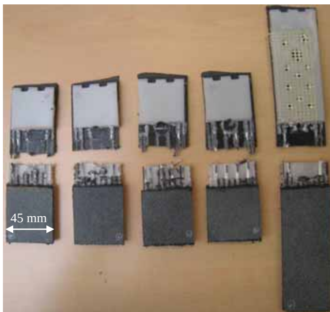
Figura 34 - Corpos de prova da soldagem por vibração ensaiados por Lap Shear a 23°C
