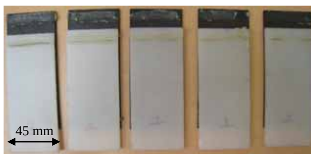
a) CT: Ruptura coesiva
