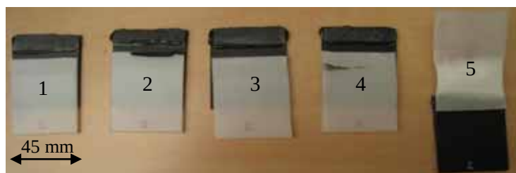
b) Teromix 6700 (PU): 1 a 4 - Ruptura adesiva 5-Deformação do c.d.p.
