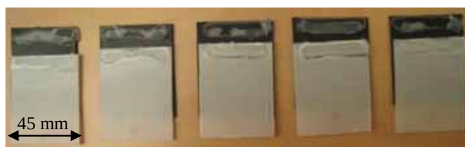
c) Pur-Fect 310 (PU): Ruptura coesiva
