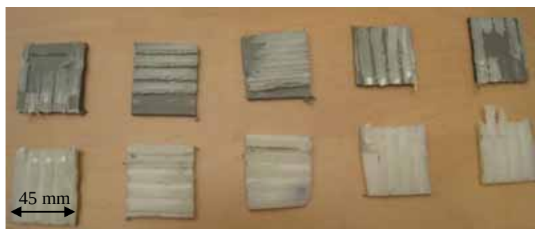
Figura 37 - Corpos de prova da soldagem por vibração ensaiados por Lap Shear a 85°C
