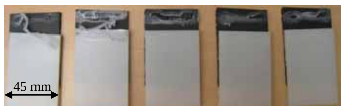
a) Reticulação: 96h – Ruptura adesiva
