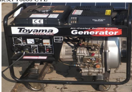
Figura 17 – Grupo motor gerador diesel T6000 CYE
