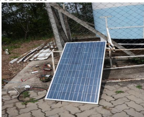
Figura 18 - Painele fotovoltaico Yingli YL 245P-29b
