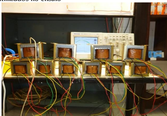
Figura 33 - Transformadores utilizados no ensaio
