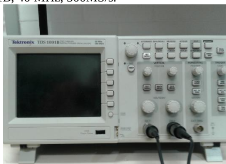
Figura 13 – Osciloscópio TDS – 1001B, 40 MHz, 500MS/s.
