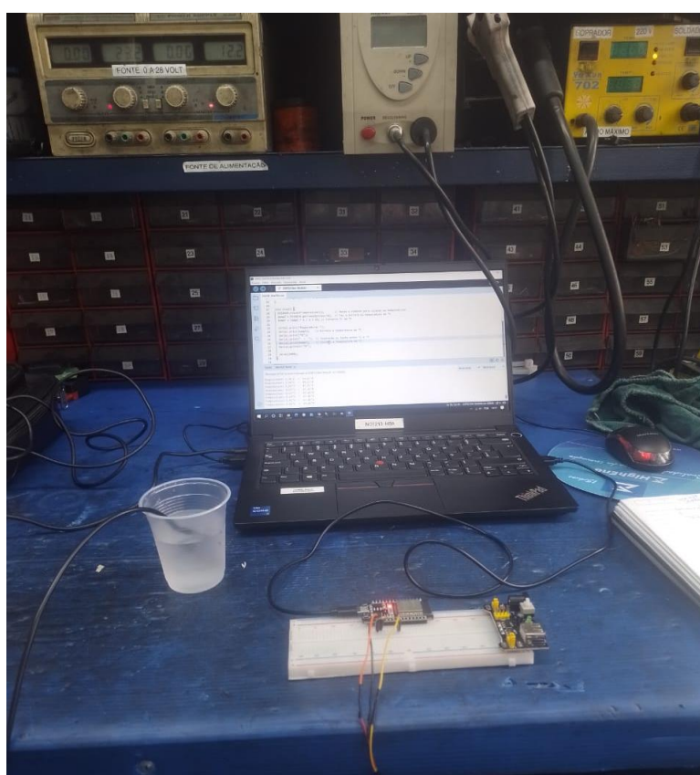
Figura 8- Teste inicial de bancada do sistema proposto
