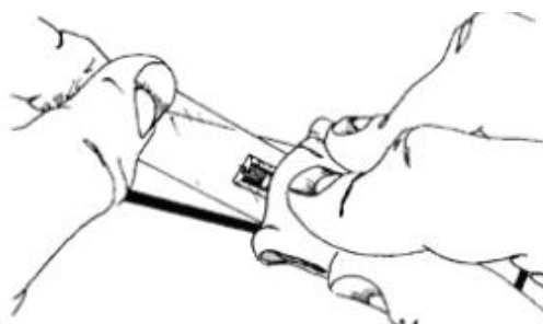
Figura 24 –Aplicação do extensômetro na área de colagem.
