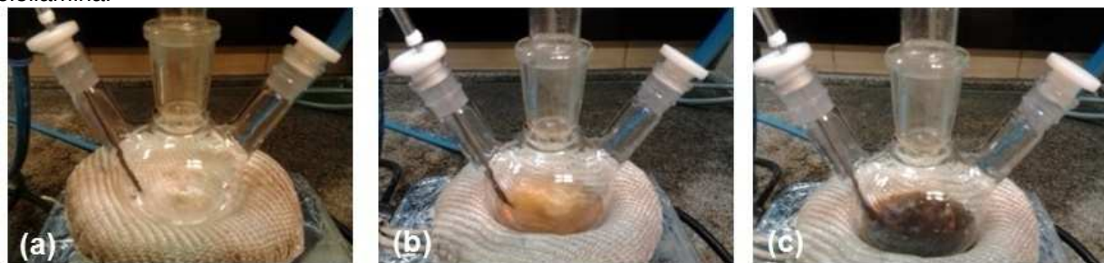
Figura 17 - Fotografias de cada etapa da síntese das NPs de Ag@AO/OL: (a) Antes do aquecimento, (b) a 60°C antes da adição de ácido oléico e oleilamina e (c) a 80°C após a adição de ácido oléico e oleilamina.
