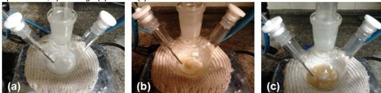
Figura 16 - Fotografias de cada etapa da síntese das NPs de Ag@PEG3400: (a) Antes do aquecimento, após atingir (b) 50°C e (c) 80° C.
