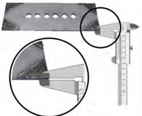
Figura 18. Esquema de medição da espessura da borda cortante das facas.
