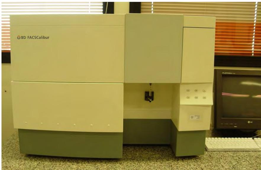
FIGURA 20- Citômetro de fluxo utilizado para a análise de caracterização das células da medula óssea.
