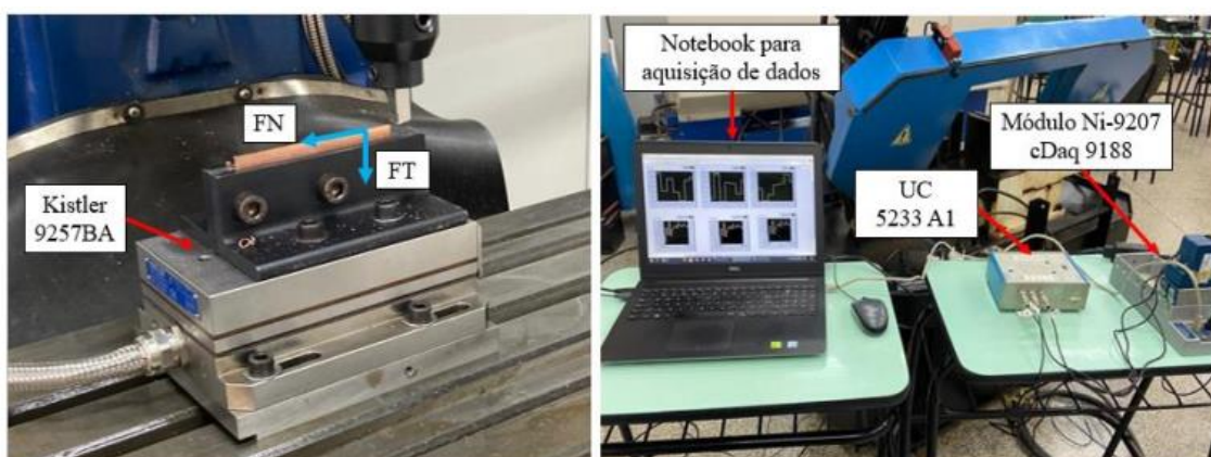
Figura 7 – Configuração para aquisição de forças (Ribeiro, 2024).
