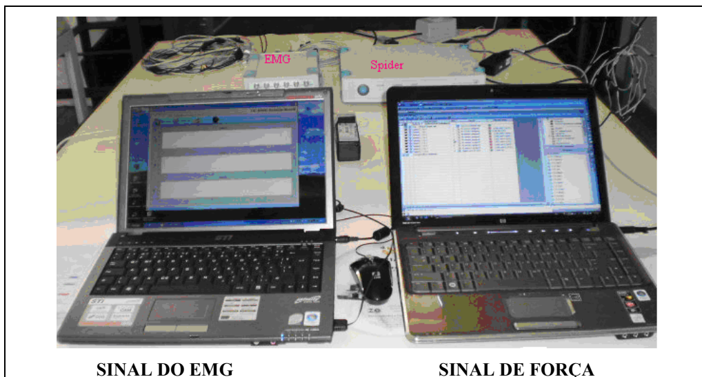
Figura 16 – Registro simultâneo dos sinais EMG e da força normal no pedal durante a coleta de dados.
