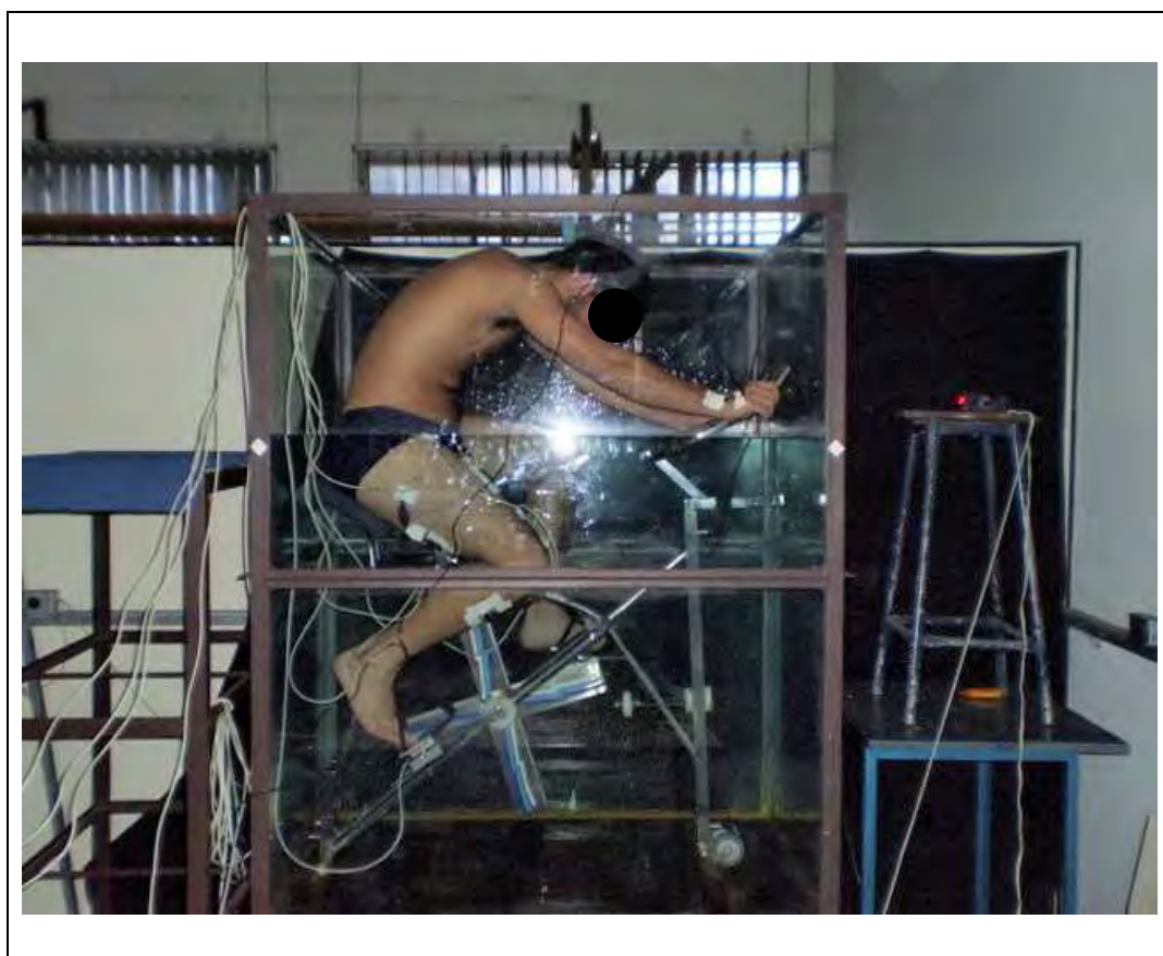
Figura 23- Coleta de dados dos sinais EMGS e dos sinais da Força Normal aplicada no pedal.
