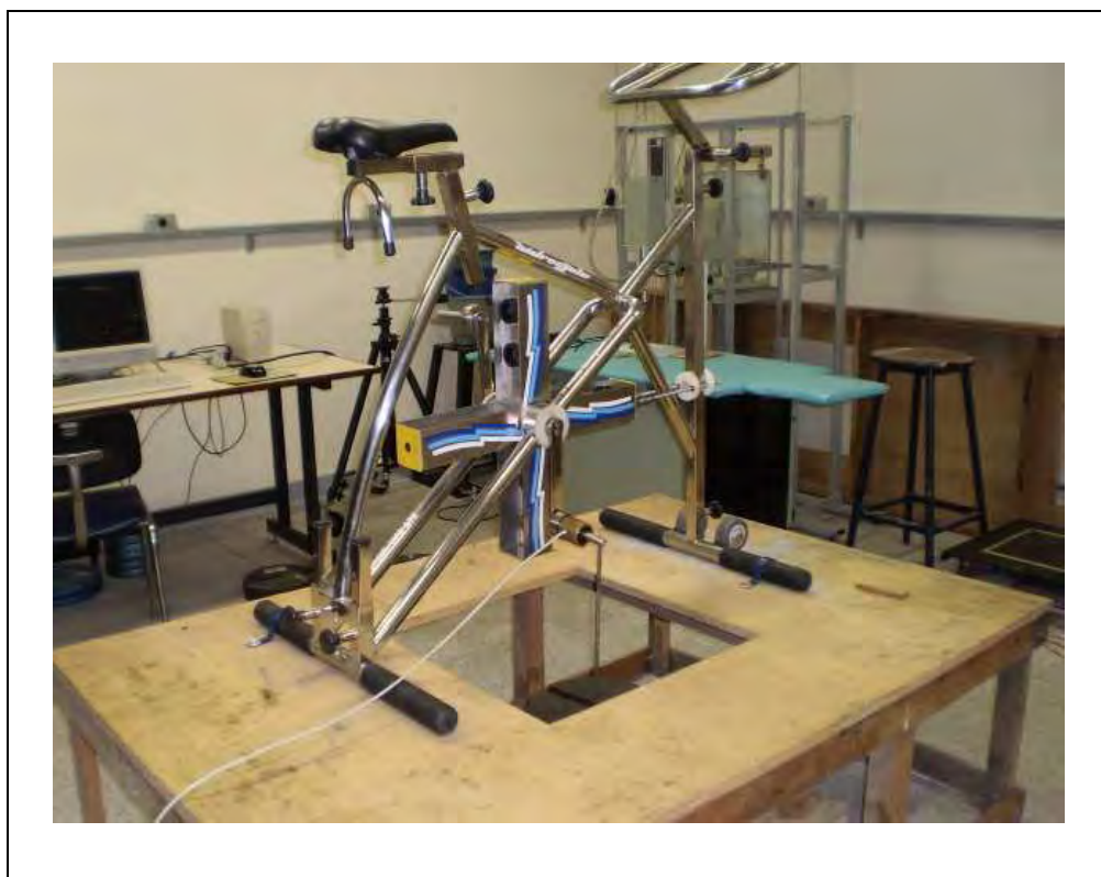
Figura 13 - Tablado de madeira utilizado na calibração do eixo do pedal
