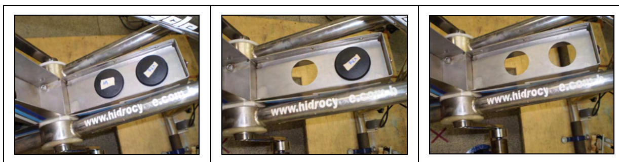
Figura 8 - Sistema de calhas da Hidrocycle com regulagem do fluxo de água (Martins, 2005).
