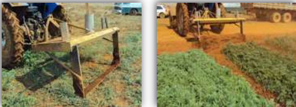
Figura 8. Lâmina de metal usada antes do arranquio manual da cenoura. Fonte: Ageitec, 2022.
