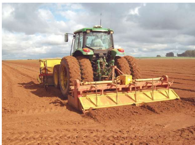
Figura 7. Trator com adubadora acoplada na dianteira e encanteirador na traseira. Fonte: Carvalho et al. (2021).
