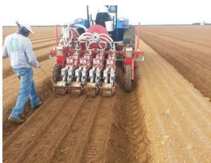
Figura 6. Semeadura de cenoura em canteiros. Fonte: https://revistacampoenegocios.com.br/tecnologia-elimina-raleio-e-reduz-custos-da-cenoura/
