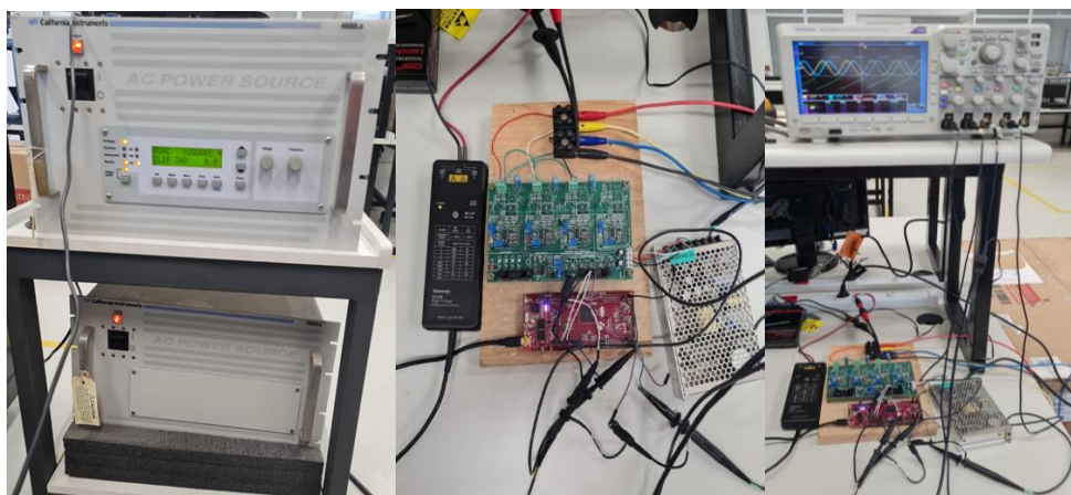
Figura 38 Fonte à esquerda e condicionador ao meio e sistema à direita, no laboratório GASL.
