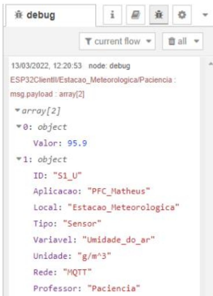
Figura 34 – Monitoramento da chegada de dados da ESP32 no Node-RED.
