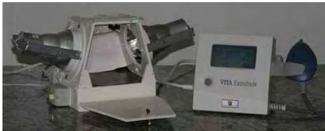
FIGURA 9 – Câmara com intensidade de luz padronizada.
