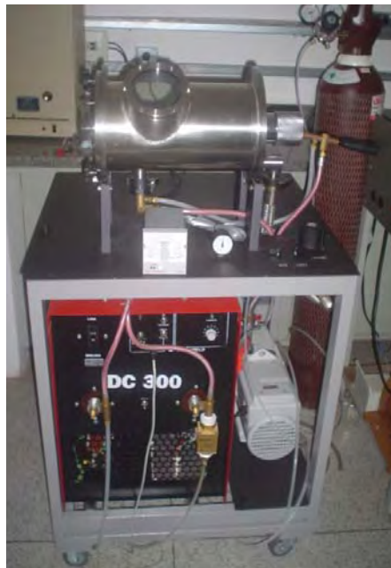
Figura 9 – Forno de fusão à arco voltaico utilizado na fusão das amostras.
