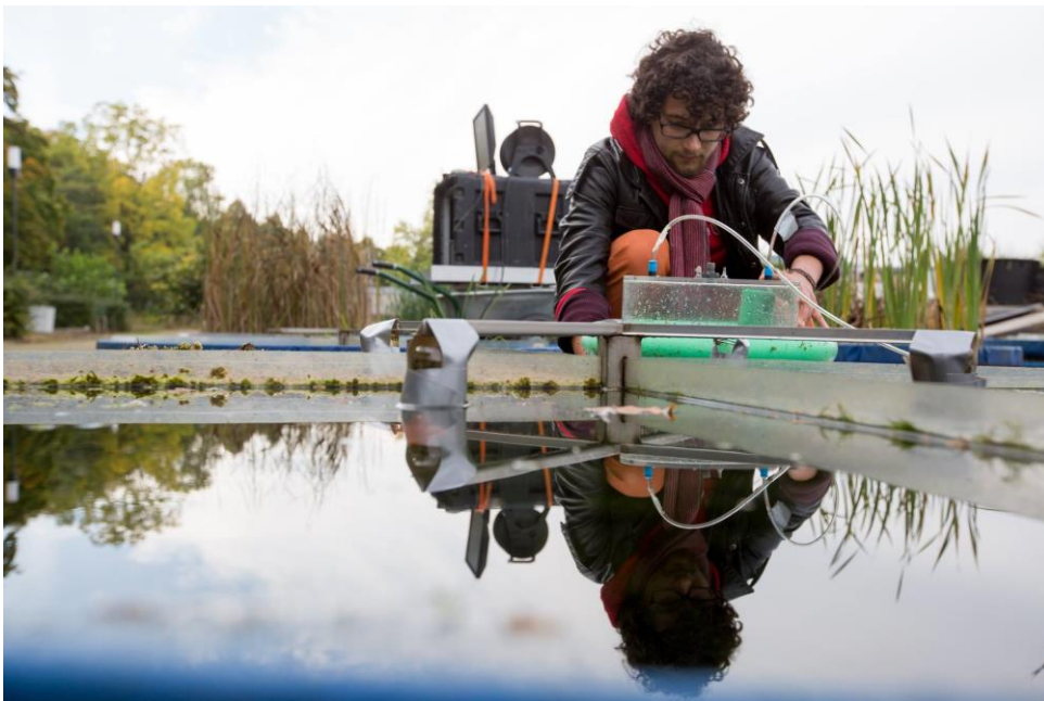
Figura 4: A difusão nos mesocosmos sendo medida, com a câmara flutuante anexada ao Picarro (GHG analyzer) ao fundo
