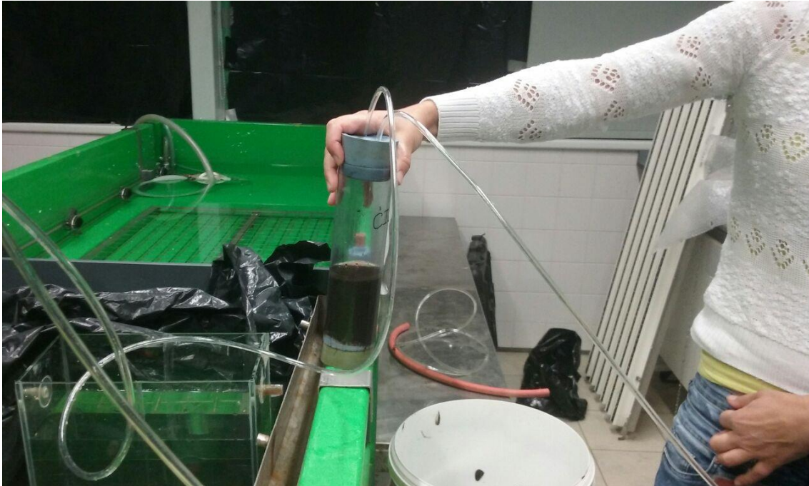
Figura 5: Medindo os fluxos dos cilindros com sedimentos após a incubação
