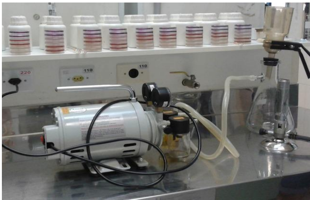
Figura 4: Kit de filtração utilizado para realizar a técnica de membrana filtrante.
