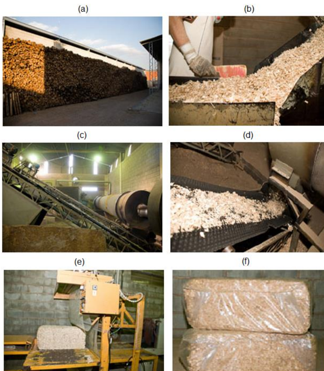
Figura 10: Processo de produção de maravalha, (a) patio de toras, (b) corte, (c) secagem da maravalha, (d) tratamento à quente, (e) compactação, (f) embalagem
