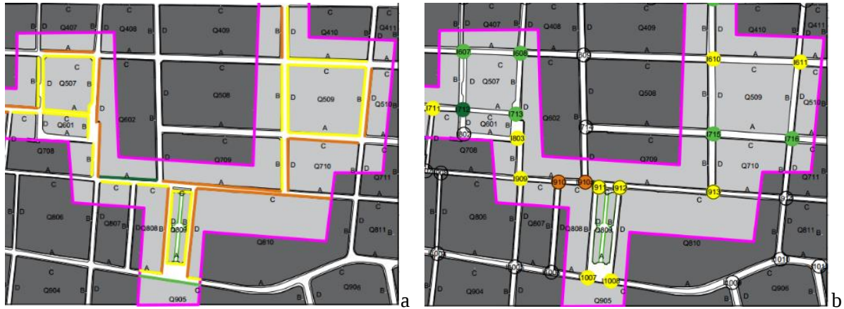
Figura 14 - Exemplo de mapeamento do nível de qualidade para: a) calçada ou fachada; b) travessia.
