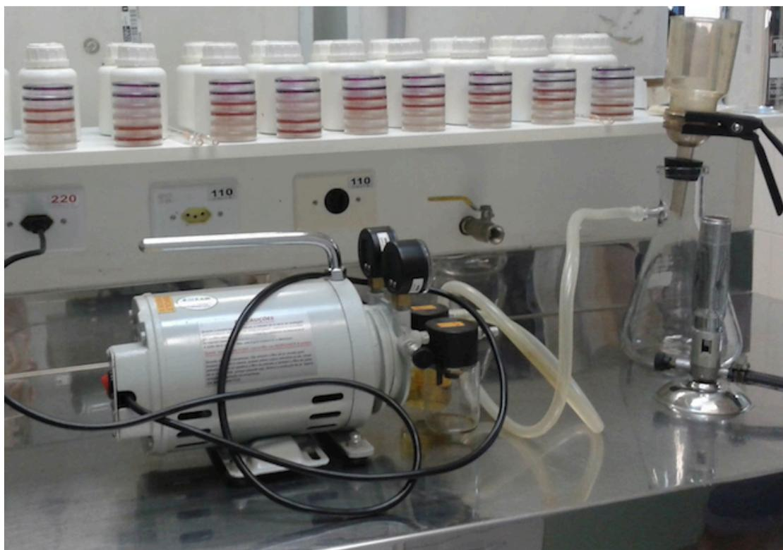
Figura 4. Kit de filtração utilizado para realizar a técnica de membrana filtrante (Micromar, 2016).
