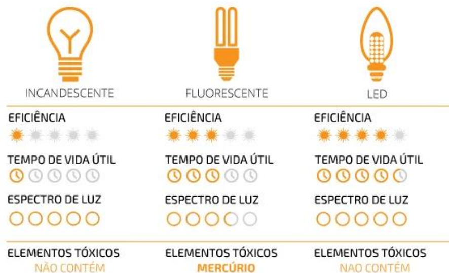
Figura 28 - Comparação dos principais tipos de lâmpadas.
