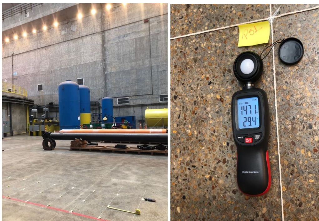
Figura 37 - Malha de Iluminância no plano de uso de trabalho (esquerda) e Luxímetro medindo a iluminância no solo
