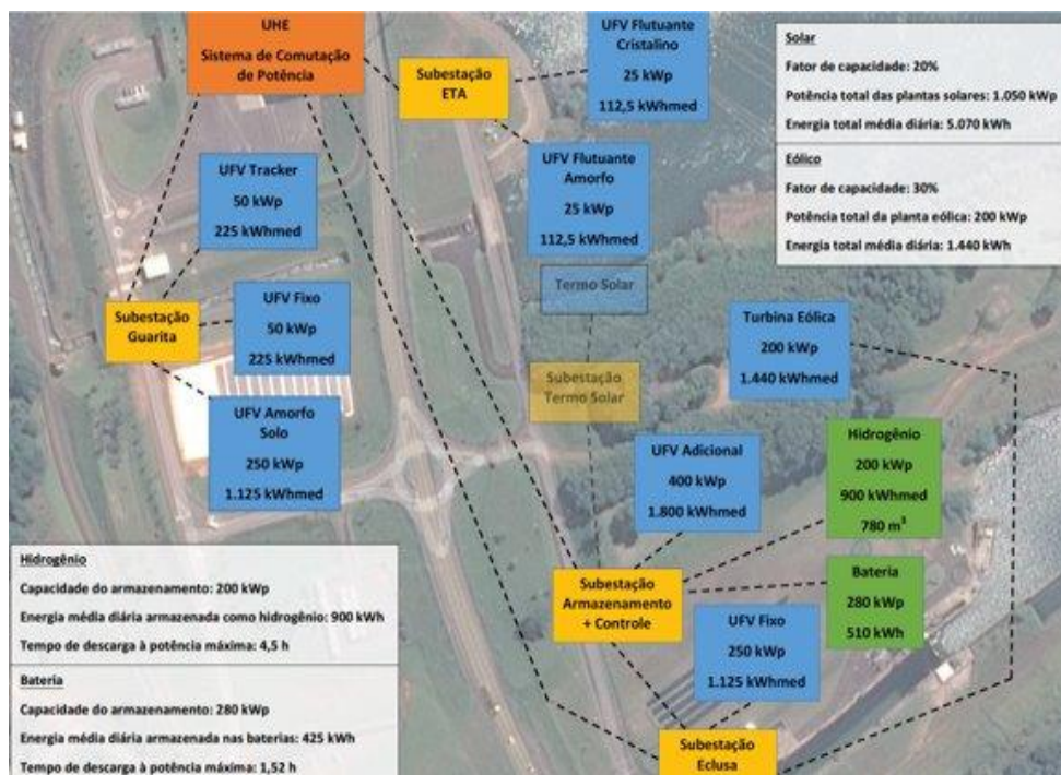
Figura 3 - Complexo Energético de energias renováveis CESP – UHE Porto Primavera, e suas respectivas potências instaladas
