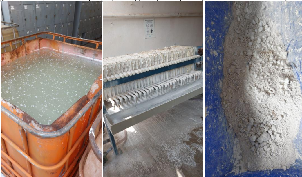
Figura 2 – Tanque de decantação (esquerda), filtro-prensa (centro) e resíduo de lente ocular (direita).
