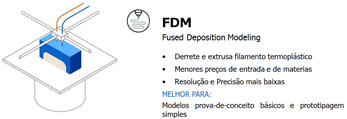
Figura 8 - Infográfico do funcionamento da impressora FDM.
