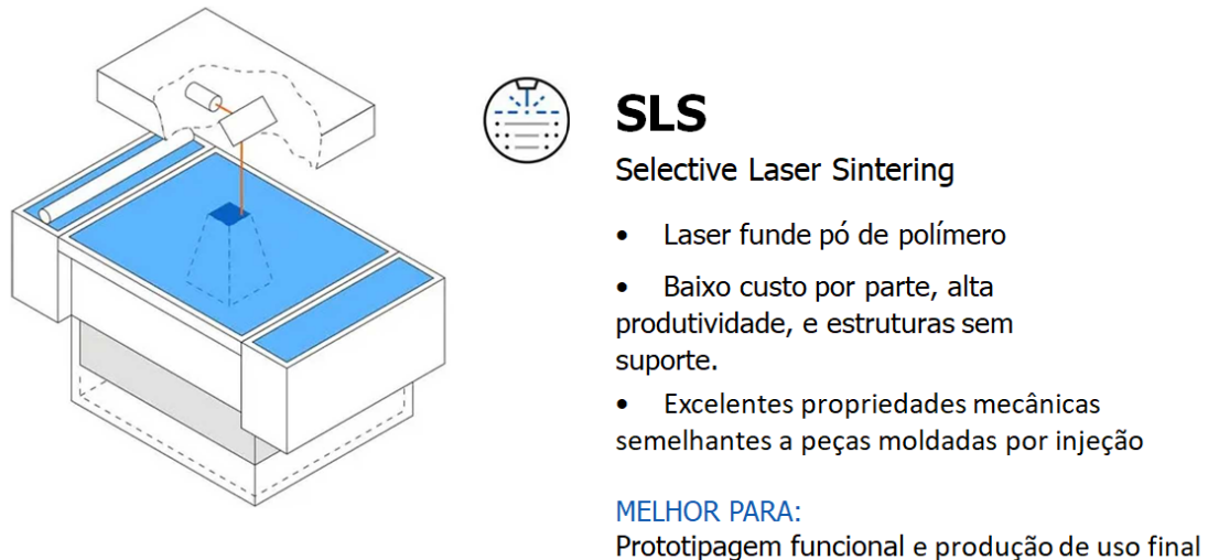
Figura 7 - Infográfico do funcionamento da impressora SLS.
