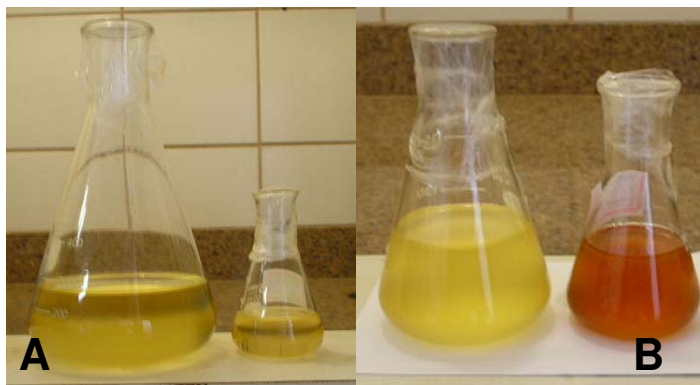
FIGURA 7. A) Produtos gerados da reação com etanol (Biodiesel + Glicerina); B) Produtos gerados da reação com metanol(Biodiesel + Glicerina)
