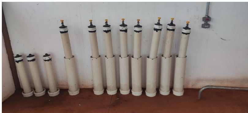
Figura 2. Biodigestor batelada, com teste de estanquidade realizado
