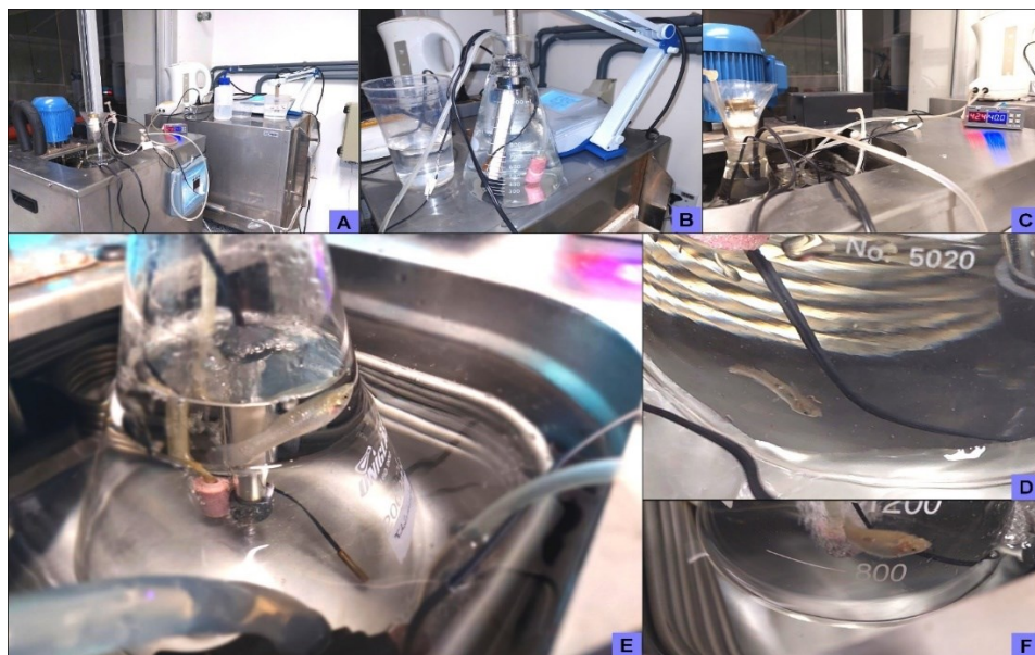
Figura 4. (A) Equipamento de banho Ultratermostático Microp. com circ. - Q214M (Quimis) . (B) Verificação de temperatura e pH, (PHMETRO de bancada com ATC. PH0-14). (C) Controlador de temperatura Stc-3008 Termostato e Controlador de temperatura duplo, ligados a termostatos eletrônicos 50 Watts e equipamentos de aeração e recirculação (Compressor De Ar Maxxi Power Pro-9000). (D) Peixes P. caudimaculatus colocado para
