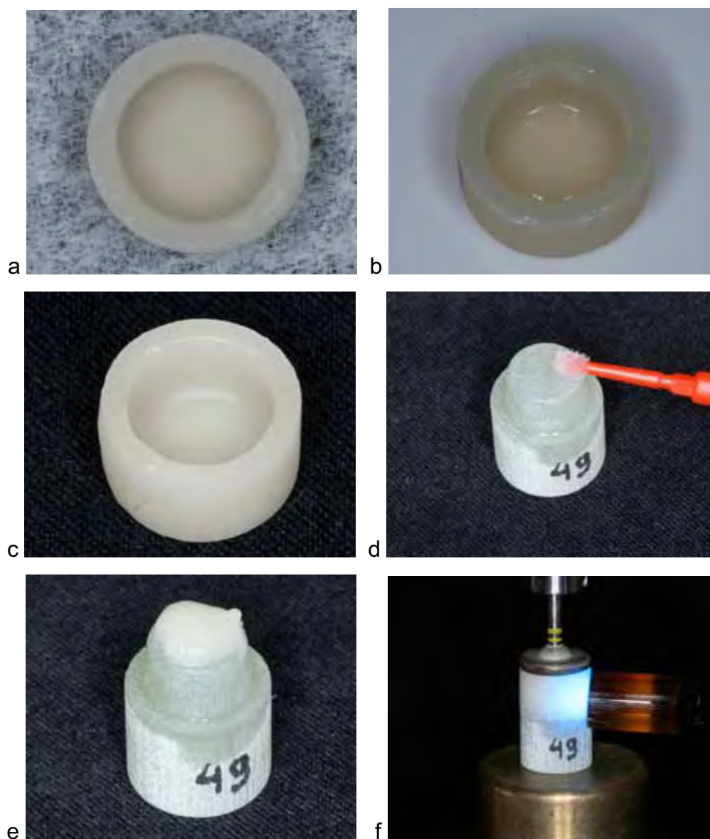
Figura 7 - Coroa cerâmica após condicionamento ácido (a), coroa preparada para “ausência de união”, após aplicação de PDMS (b), coroa silanizada para procedimento de “união” (c), tratamento do troquel com mistura dos primers A e B (d), cimento aplicado na face oclusal do troquel (e), coroa assentada no troquel, sendo submetida à carga de assentamento constante durante a fotoativação (f)
