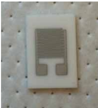
Figura 11: Eletrodos interdigitais de platina em substrato de alumina, utilizados para as medidas sensoras.
