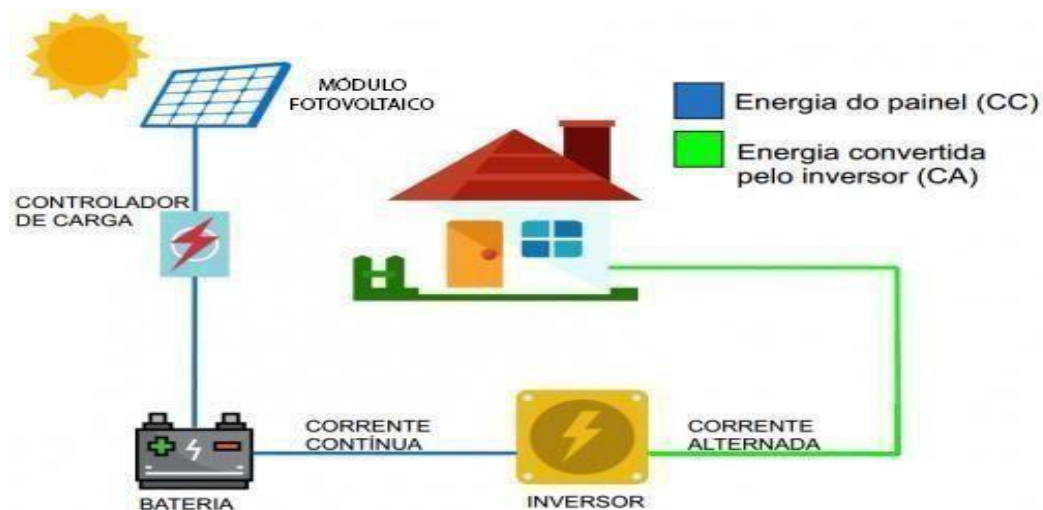
Figura 20 – Sistema OFF Grid
